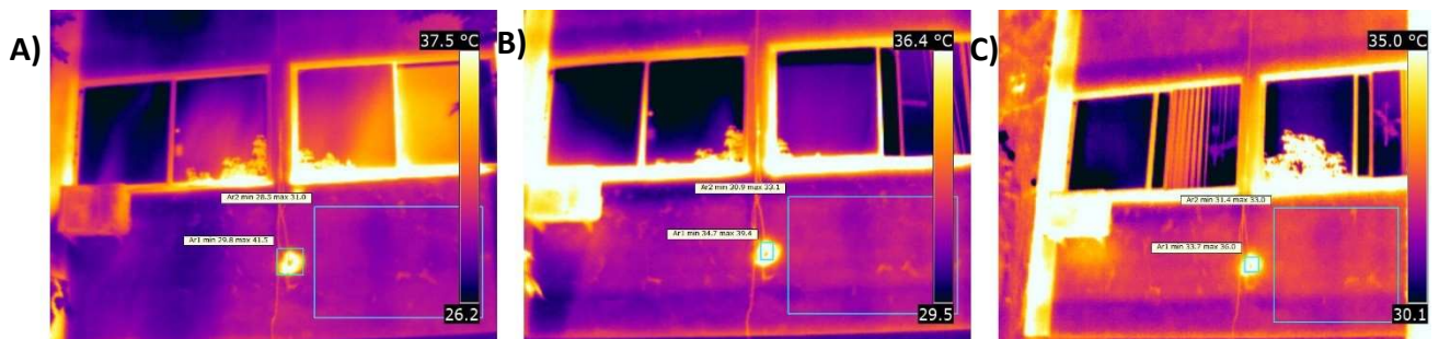
Figura 47 – Termograma às 8h30 (“A”), 10h00 (“B”) e 12h00 (“C”), da amostra D4.
