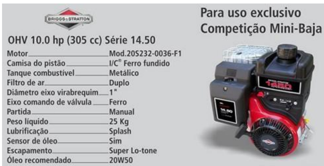
Figura 19 - Motor Briggs & Stratton OHV 10 HP. Catálogo Vipeças, acessado em 2014.
