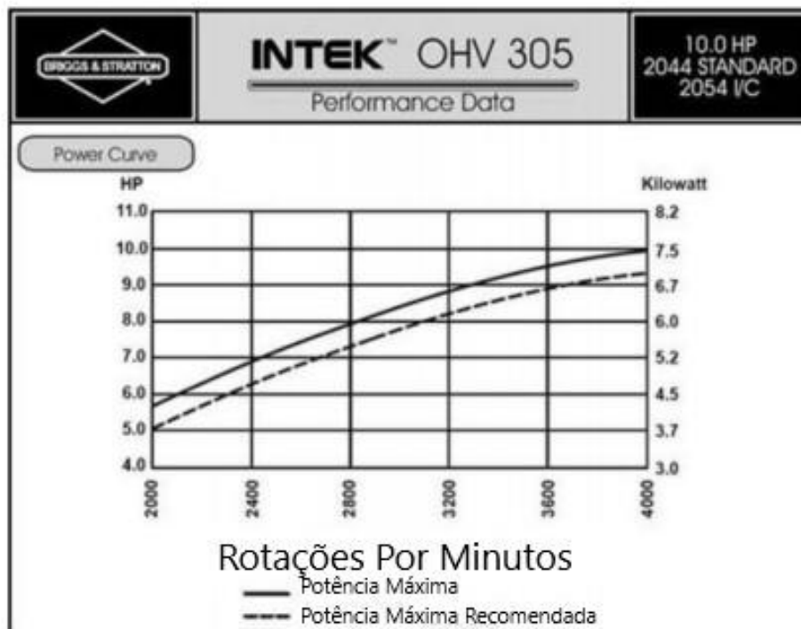
Figura 20 - Curvas de torque motor Briggs & Stratton OHV 10 HP. (SOUSA, 2011 apud BRIGGS & STRATTON, 1999).
