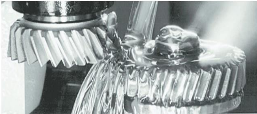
Figura 10 - Processo de usinagem de uma engrenagem helicoidal. (NORTON, 2013).
