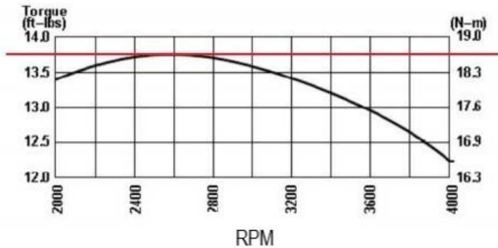
Figura 20 - Curvas de torque motor Briggs & Stratton OHV 10 HP. (SOUSA, 2011 apud BRIGGS & STRATTON, 1999).
