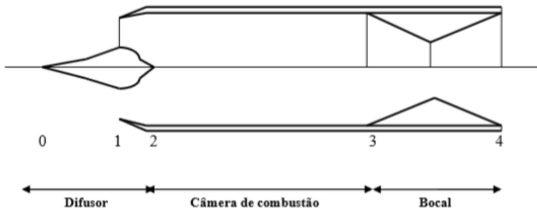
Figura 6 – Esquemático dos processos termodinâmicos em um Ramjet ideal
