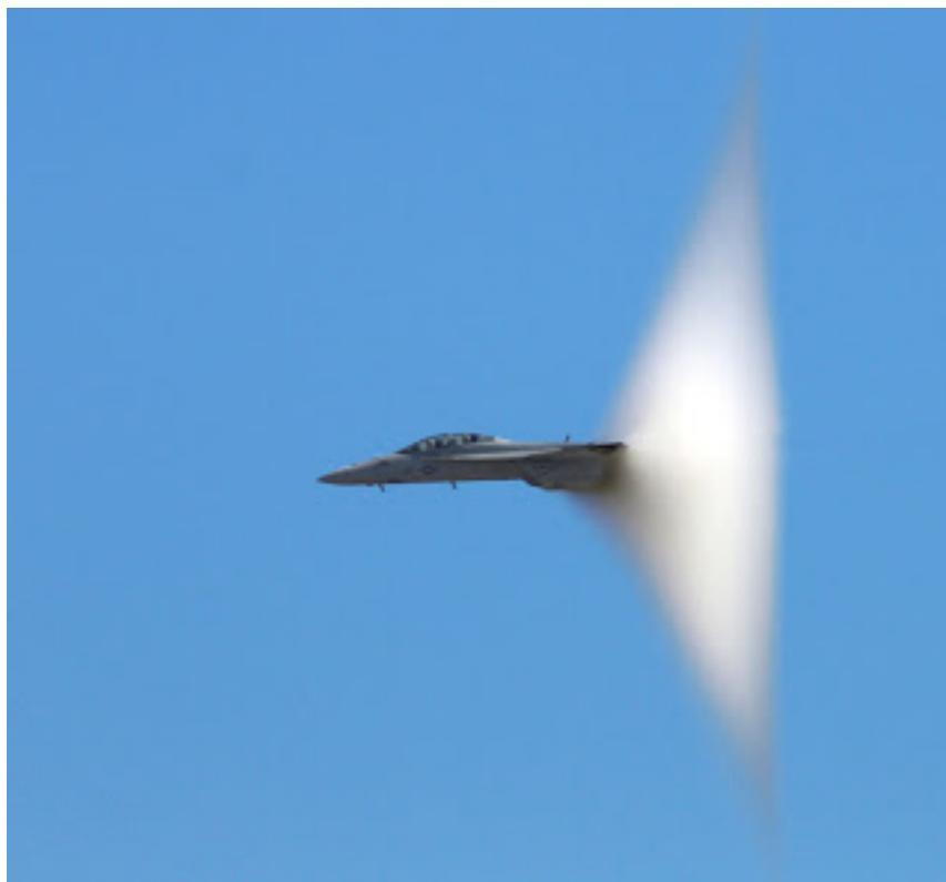
Figura 2 – fenômeno da onda de choque
