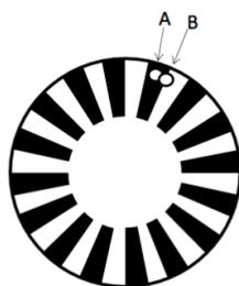
Figura 2.5: Encoder incremental com sensores em quadratura
