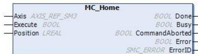
Figura 5.13 - Bloco de função MC\_Home
