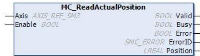
**Figura 5.16 - Bloco de função MC\_ReadActualPosition**
