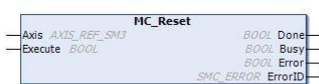
Figura 5.10 Bloco de função MC\_Reset
