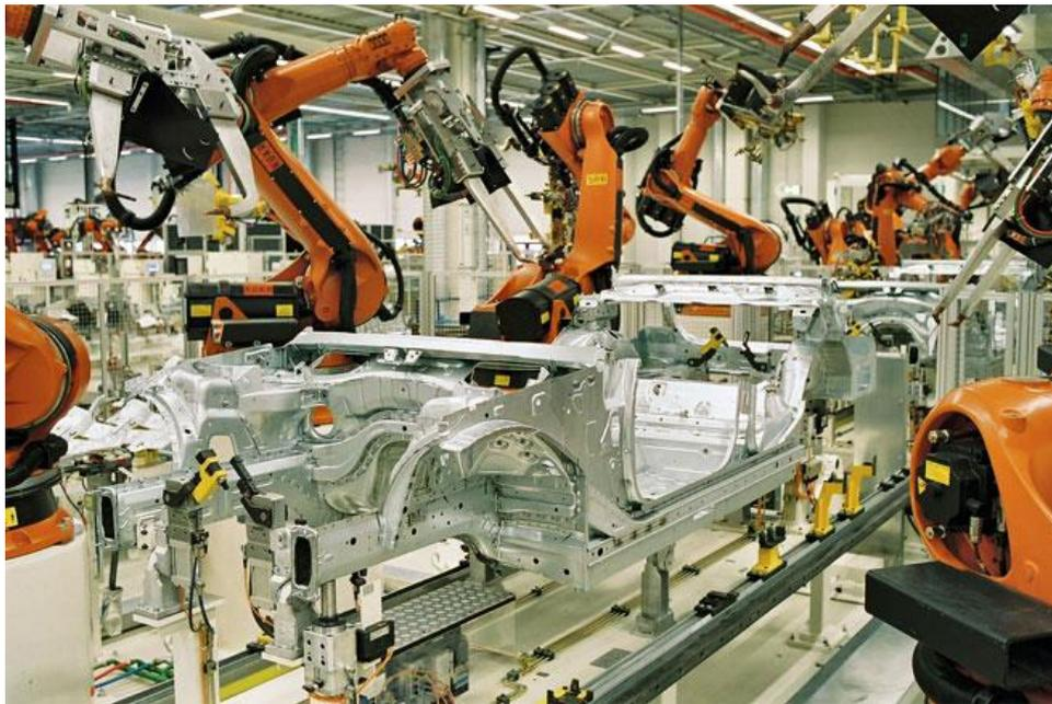
Figura 2.1 - Manufatura robotizada para produção de automóveis [19]
