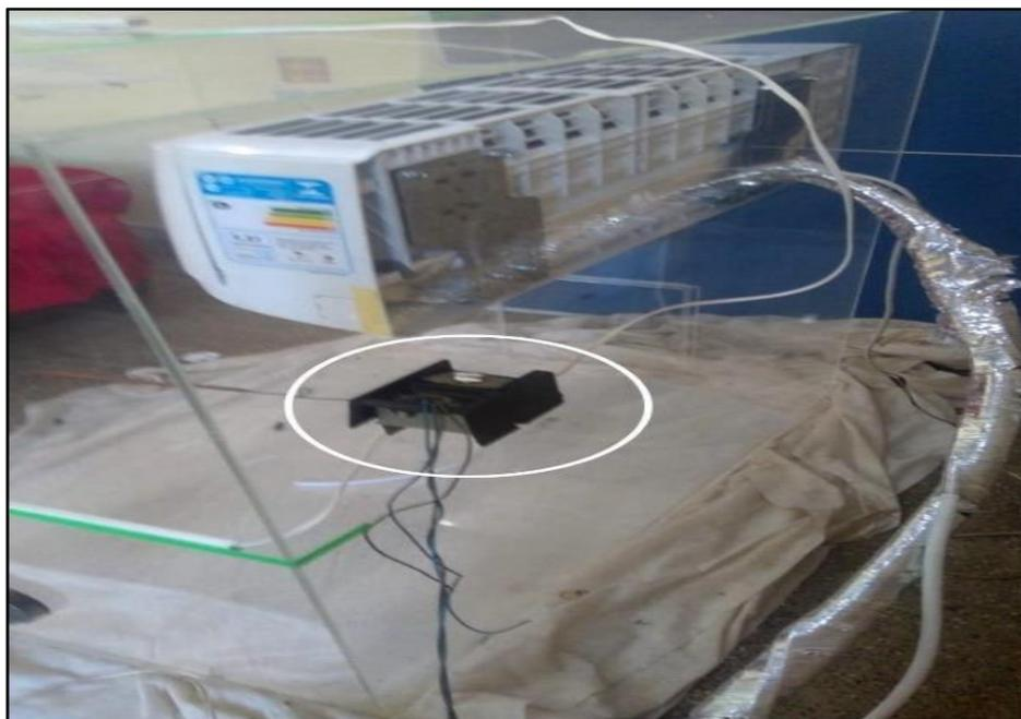
FIGURA 3 - Ar condicionado tipo Split com 7.000 BTU de potência instalado no protótipo reprogramado do modo “automático” para o sistema “analógico” para resfriamento da temperatura interna e circulação de ar. Fonte: arquivo pessoal (2018).
