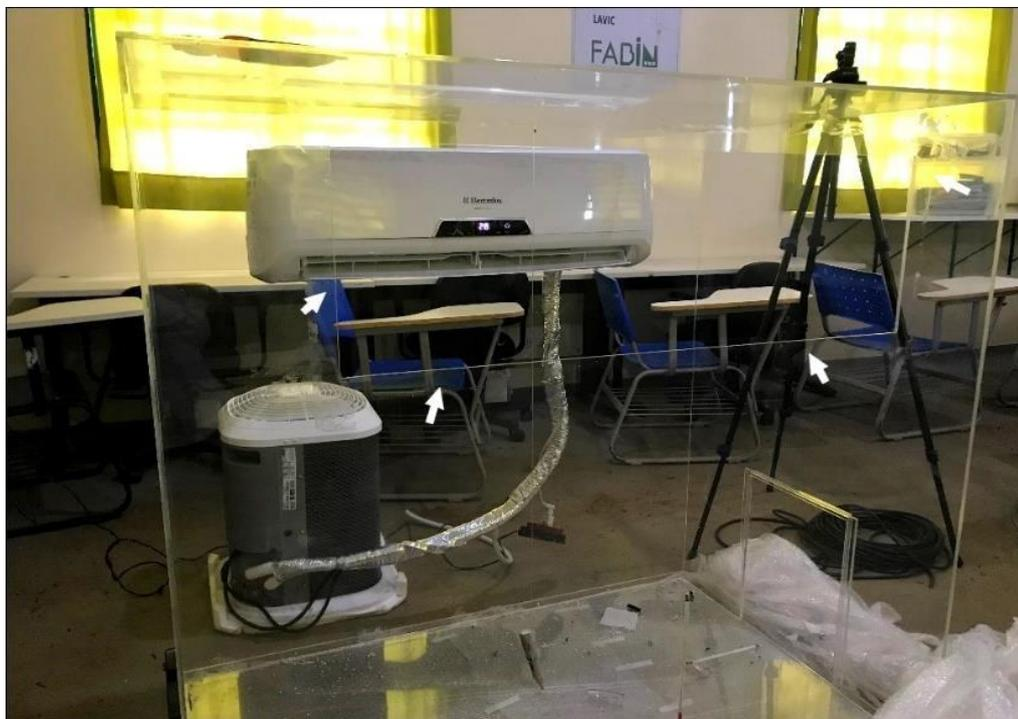
FIGURA 2 – Protótipo com a instalação do ar condicionado do tipo Split com 7.000 BTU de potência e abertura (visualizada pela seta branca) frente ao ar condicionado para o manejo da lâmpada de infravermelho, ambas do mesmo tamanho. Fonte: arquivo pessoal (2018).
