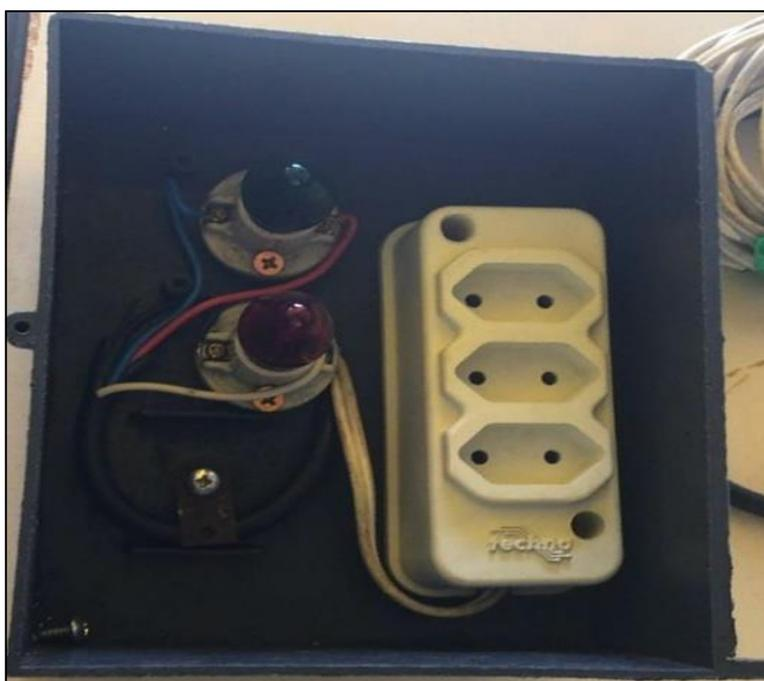
FIGURA 4 – Aparato utilizado para averiguar o funcionamento do sistema analógico. A lâmpada vermelha ligada indica que a lâmpada infravermelha está funcionando e aquecendo o ar junto ao ar condicionado na função “ventilação”. A lâmpada verde ligada indica que o modo “resfriamento” do ar condicionado está funcionando (entre 18 e 20 °C) e que a lâmpada infravermelha está desligada. Fonte: arquivo pessoal (2018).
