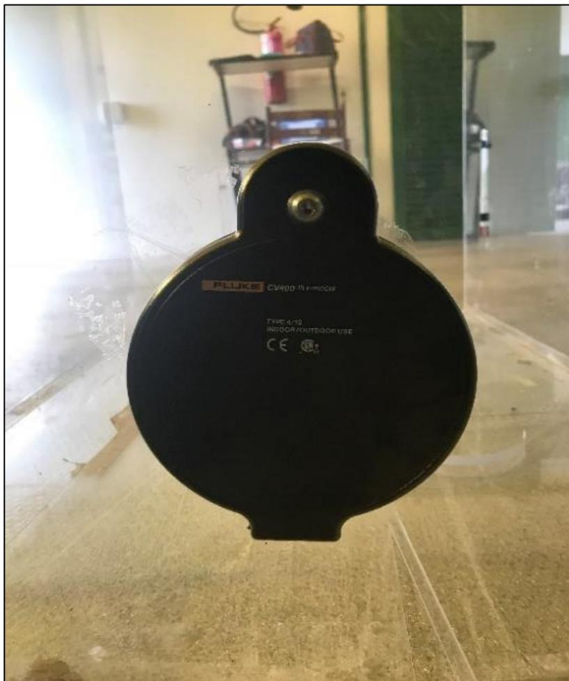
FIGURA 6 - Janela de inspeção termográfica do protótipo para aferição da temperatura superficial dos animais no interior do aparato por intermédio da câmara de infravermelho. Fonte: arquivo pessoal (2018).
