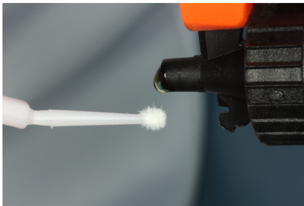
Figura 12. Aplicação do sistema adesivo
