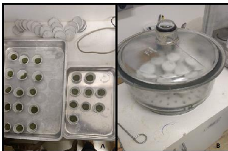
Figura 7 – Etapas da análise de matéria seca. (A) Cadinhos com as sub-amostras pesadas; (B) Cadinhos no dessecador após 16 horas na estufa. Fonte: Arquivo Pessoal.
