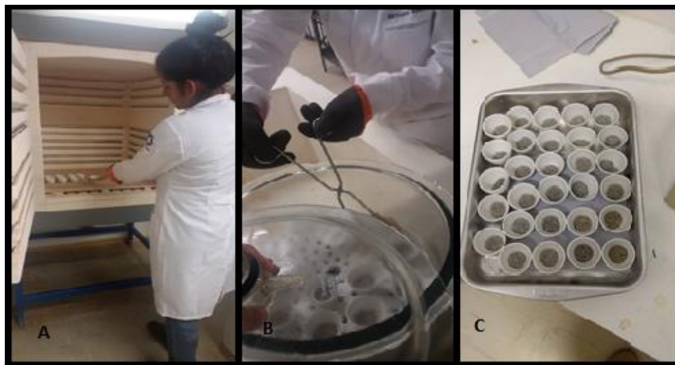
Figura 8. Etapas da análise de matéria mineral. (A) Retirada dos cadinhos da mufla, após período de 4 horas a 600 °C; (B) Cadinhos colocados no dessecador; (C) Finalização da pesagem. Fonte: Arquivo Pessoal.
