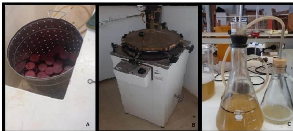
Figura 10. Etapas da análise de Fibra em detergente neutro. (A) Etapa de preparação das amostras no cesto da autoclave; (B) Etapa de aquecimento das amostras em detergente neutro; (C) Etapa de filtragem das amostras. Fonte: Arquivo Pessoal.
