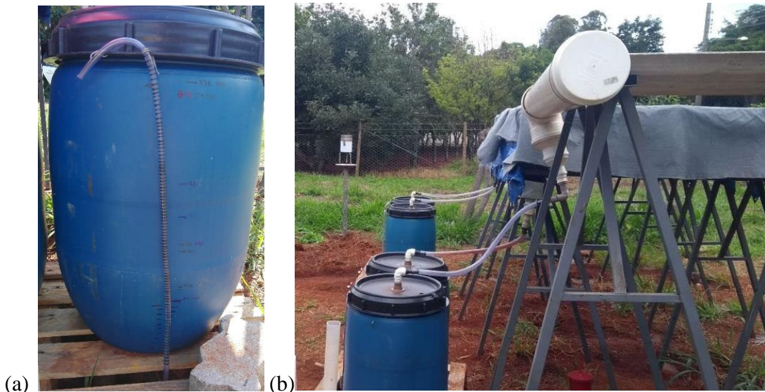
Figura 4.8: Graduação das bombonas (a) e sua ligação com as unidades piloto (b) para verificação do volume armazenado (2018).
