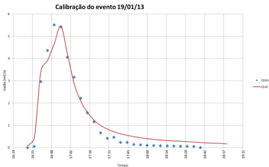
Figura 5.6: Gráfico dos resultados da Vazão observada (Qobs) e da vazão calculada (Qcal) (COSTA, 2013).
