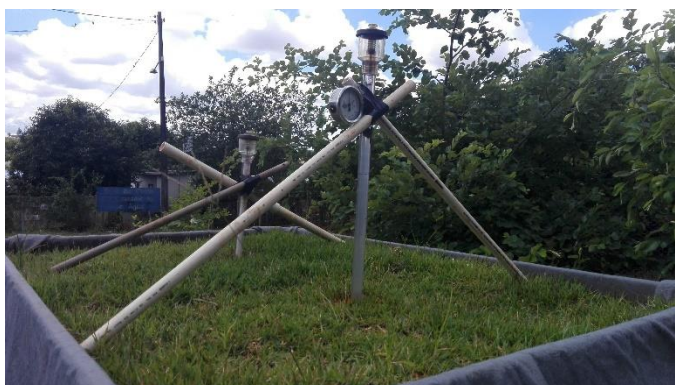
Figura 4.7: Instalação dos tensiômetros para monitoramento da umidade do solo (2018).
