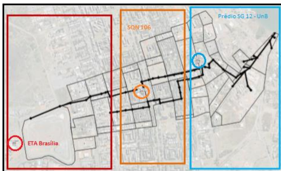
Figura 4.12: Postos pluviométricos inseridos no modelo e as sub-bacias que os englobam (adaptado; COSTA, 2013).
