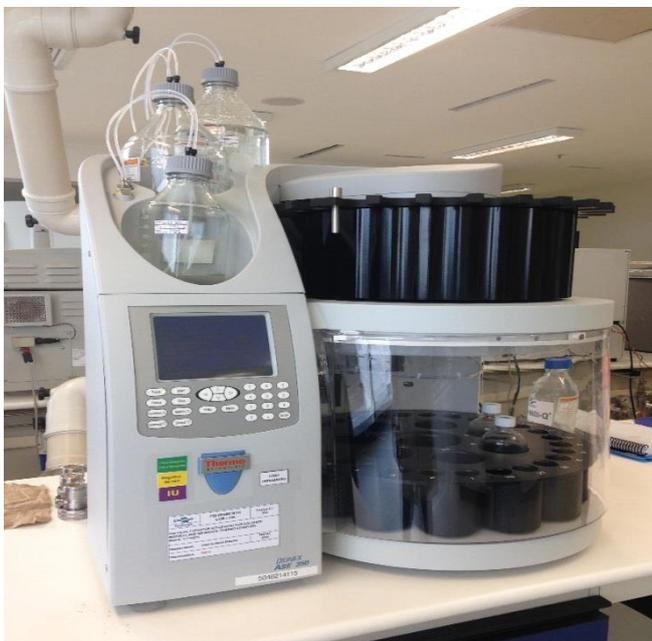
**Figura 4.** Extrator Acelerado por Solvente (ASE 350), Thermo Scientific, USA.
