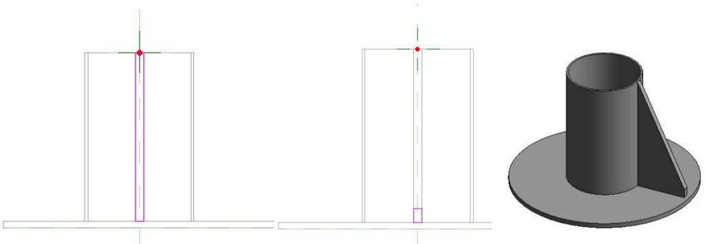
Figura 49: Desenho dos extremos da varredura e o 3D resultado da mescla com varredura.
