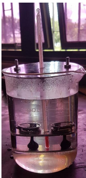
Figura 3-13 Disposição da aparelhagem para a realização do ensaio de ponto de amolecimento
