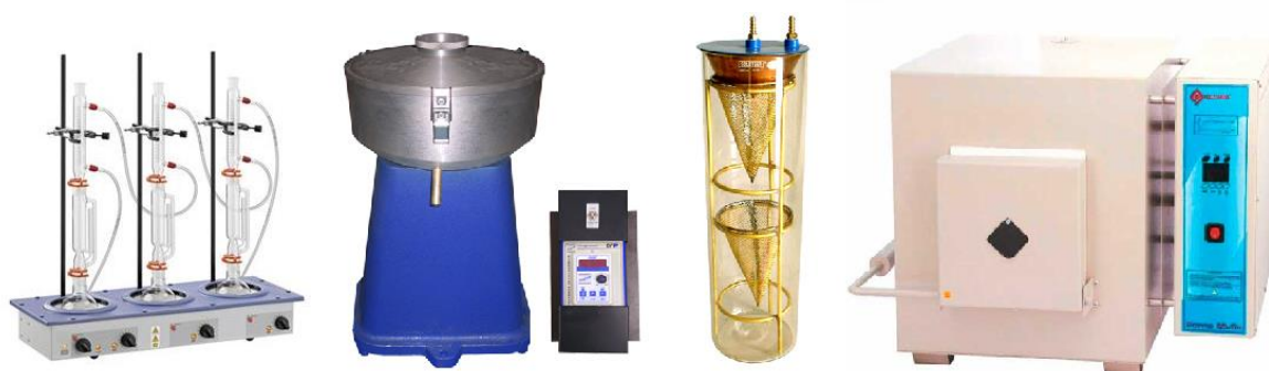
Figura 2-4 Métodos usuais de extração. Da esquerda para a direita: Soxhlet, Rotarex, refluxo duplo e forno mufla (fonte: http://www.solotest.com.br/novo/ )
