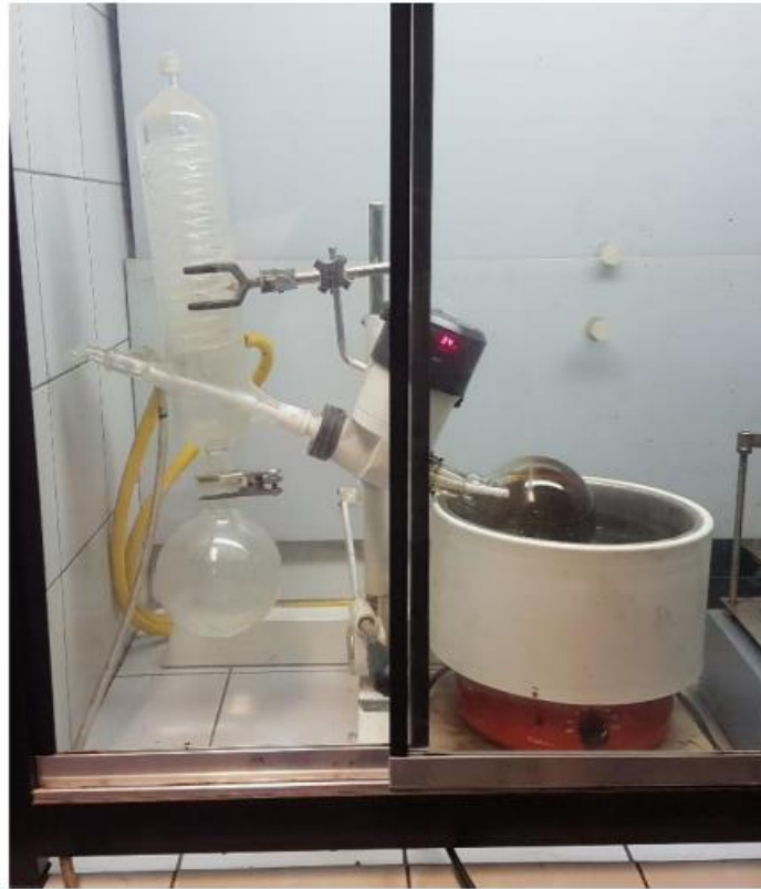
Figura 3-9 Equipamento Rotavaporador utilizado
