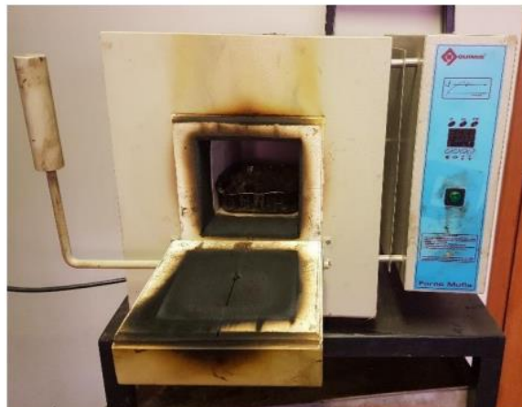
Figura 3-10 Pequena mufla utilizada para a extração de ligante por ignição
