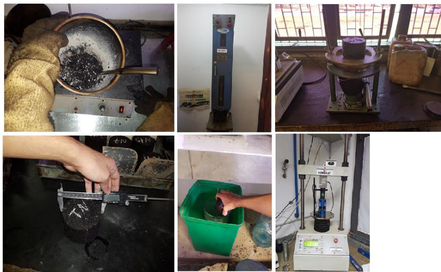
Figura 3-17 Processos para avaliação dos corpos de prova marshall: mistura, compactação, medidas das dimensões, aferição das massas específicas e compressão marshall (da esquerda para a direita, de baixo para cima)
