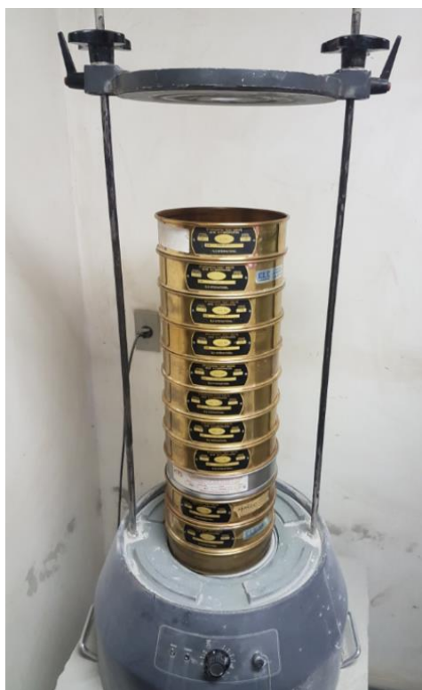
Figura 3-5 Conjunto de peneiras e peneirador mecânico utilizados para o peneiramento dos grão de agregados e dos gomos do material fresado
