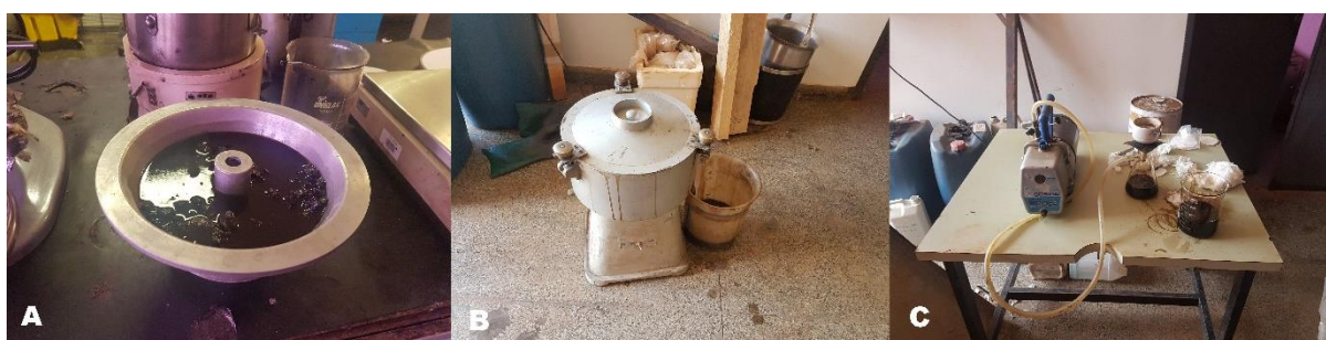
Figura 3-6 Etapas do método de extração com Rotarex (SILVA, 2011)
