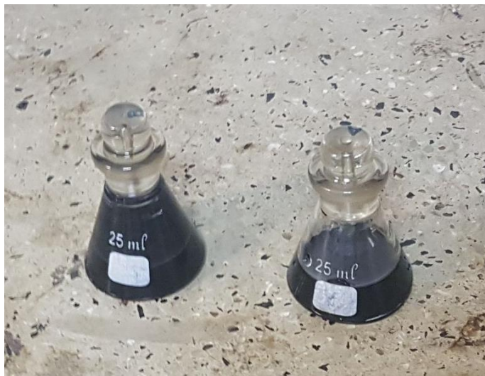
Figura 3-15 Picnômetros com ligante e água (esquerda) e com 1/3 de ligante
