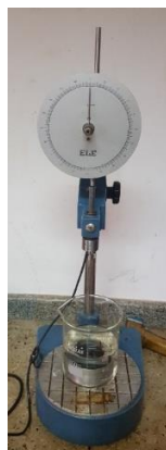
Figura 3-14 Pernetômetro com agulha usados em ensaio de penetração
