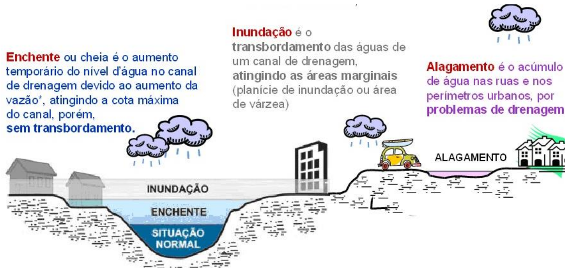
Figura 2.2. Distinção dos tipos de escoamento e acúmulo superficial de água. ( http://dscbcsp.blogspot.com.br e modificado de Carvalho et al, 2007.)
