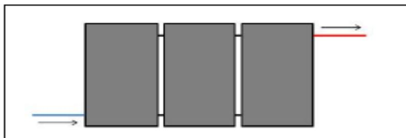
Figura 17 - Esquema de um arranjo em paralelo de coletores solares. Fonte: CAMPANIÇO, 2010.
