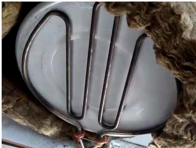
Figura 20: Resistência elétrica na base da panela
