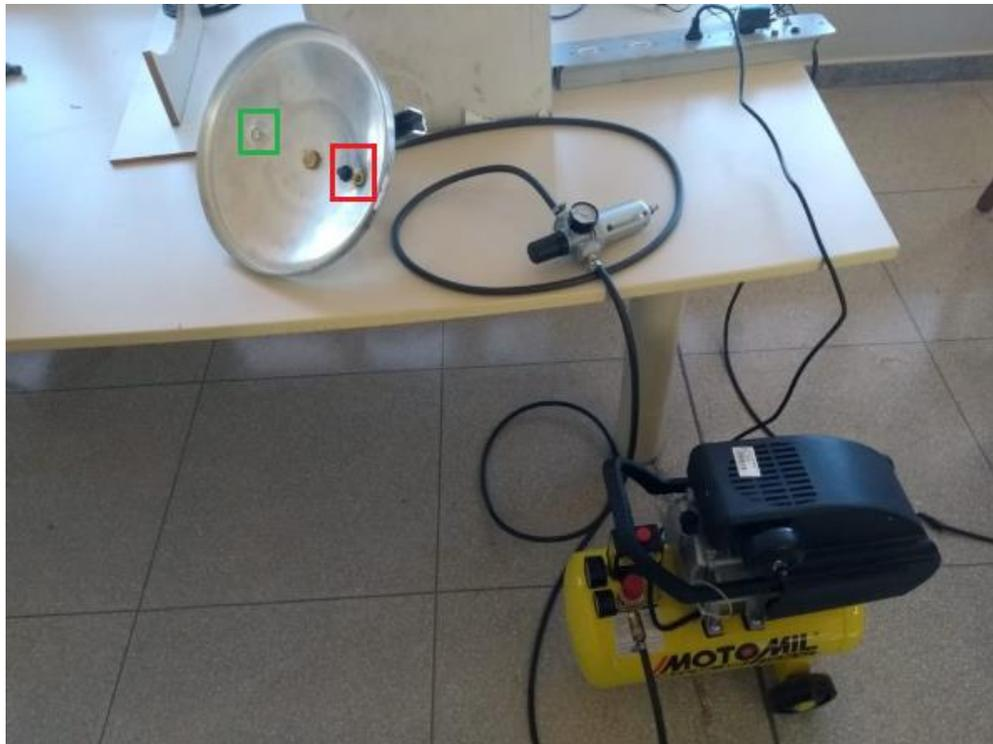
Figura 25: Sistema de pressurização contendo compressor, mangueira e regulador de pressão ligados a tampa da panela com destaque em vermelho para as válvulas de segurança de 10 psi (azul) e 15 psi (amarelo) e destaque em verde para a entrada de fluxo vinda do compressor
