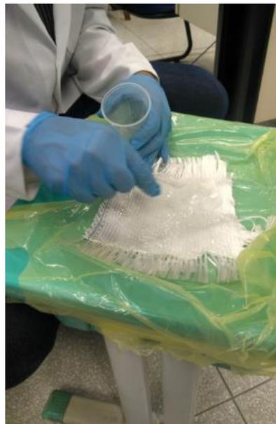
Figura 32: Aplicação da resina na fibra
