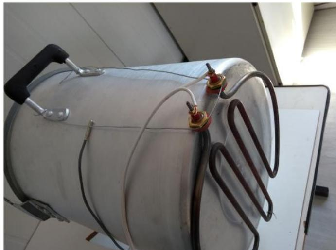
Figura 24: Estrutura de aquecimento com resistência fixada a panela pelas alças e termopar para medição e controle da temperatura
