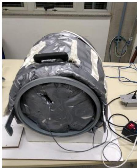
Figura 29: Isolamento móvel na fase de pré-aquecimento com termostato medindo a temperatura interna
