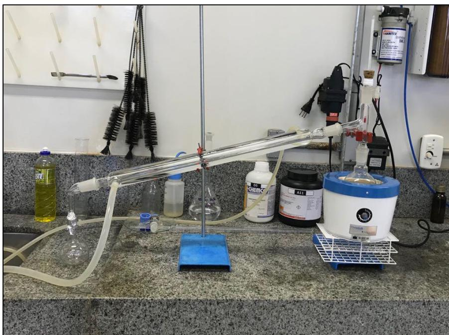
**Figura 16** - Aparato de destilação utilizado no trabalho.
