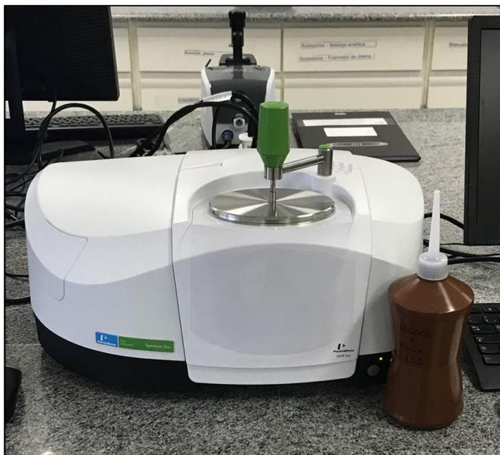
**Figura 15** - Espectrofotômetro Spectrum Two.
