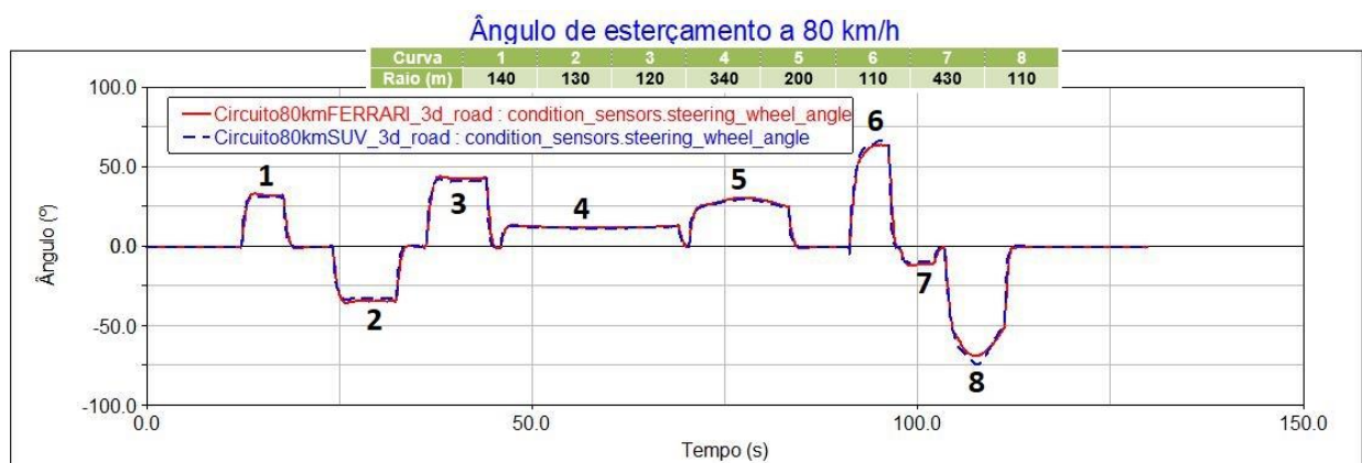
Figura 34 – Ângulo de esterçamento das rodas para realização das curvas a 80 km/h
