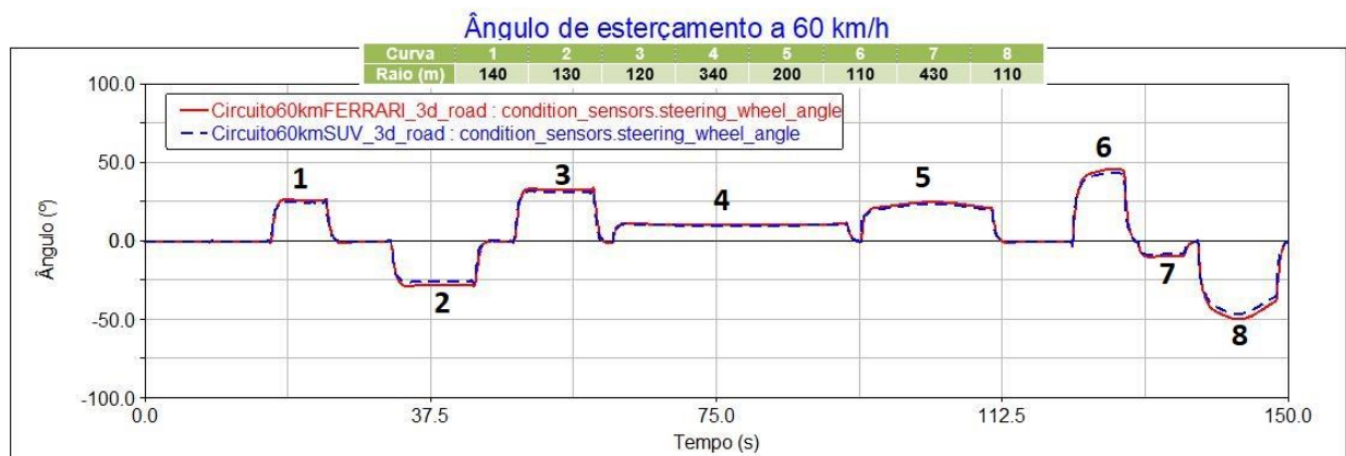
Figura 33 - Ângulo de esterçamento das rodas para realização das curvas a 60 km/h
