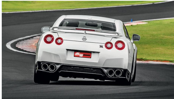
Figura 2 - Um Nissan GT-R fazendo uma curva rápida: forças longitudinais, laterais e verticais em ação (Marco de Bari/Quatro Rodas)
