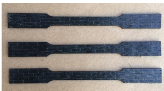
Figura 28: Corpo de prova para ensaio à tração. Fonte: Autor.
