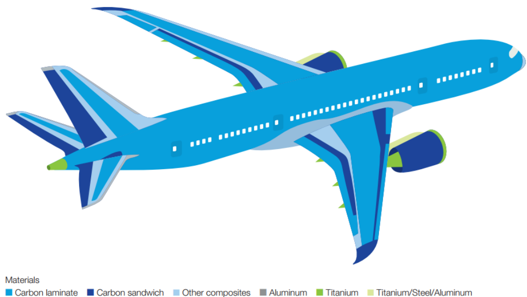
Figure 14: Utilização de material compósito no Boeing 787. Fonte: Boeing (2014).
