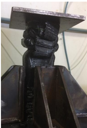
Figura 34: AE com formação de lóbulos no confinamento. Fonte: Autor.
