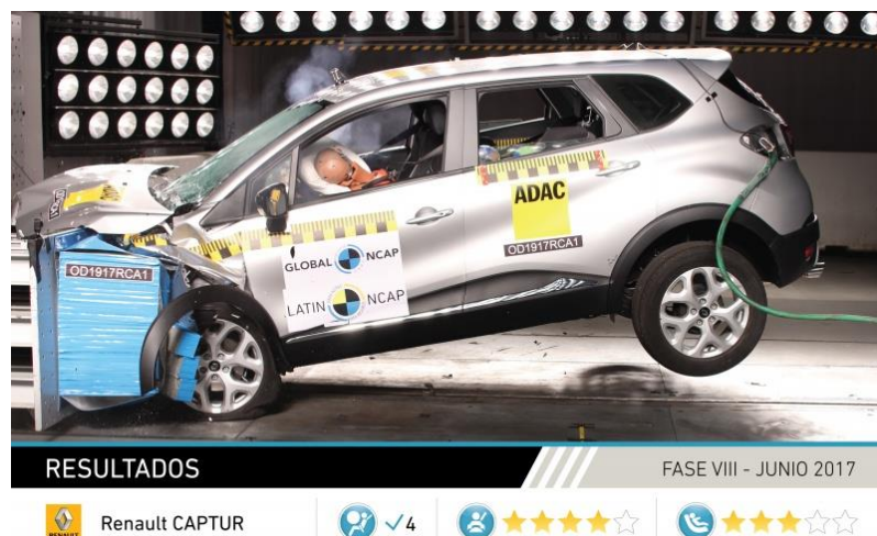
Figure 5: Crash test realizado em um Renault Captur. Fonte: (Latin NCAP, 2017).
