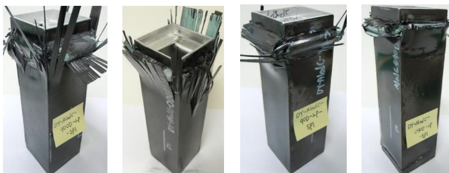
Figure 16: Formas de falha da amostra de alumínio puro e híbrido, em sequência de lay-up diferente após o teste de colisão axial. Fonte: Lee et al. (2014) – adaptada.
