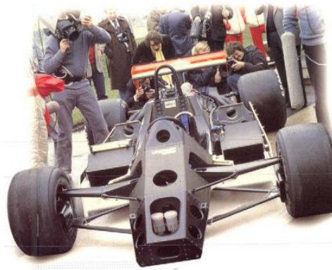
Figure 13: O primeiro carro de corrida cockpit de fibra de carbono – McLaren. Fonte: Savage (2009).
