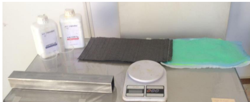
Figura 25: Mesa de preparo do corpo de prova. Fonte: Autor.
