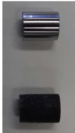
Figura 17 – Amostra antes do lixamento (embaixo) e após o lixamento (acima).
