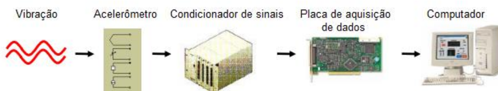
Figura 3.15 - Cadeia de instrumentação para aquisição de dados de vibração (adaptado de Serrano, et al. (2004))
