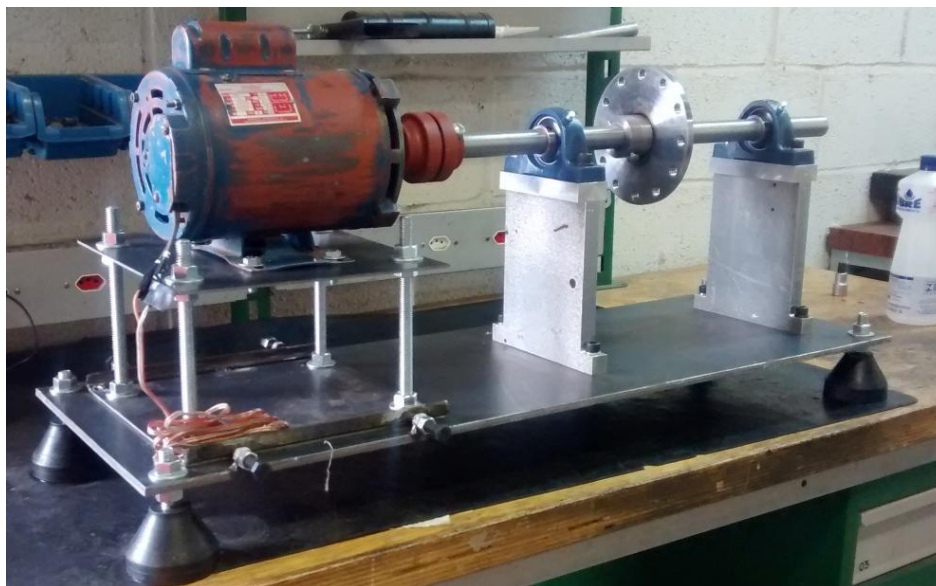
Figura 2.2 - Bancada para análise de vibração por desbalanceamento e desalinhamento (Lima, 2013)
