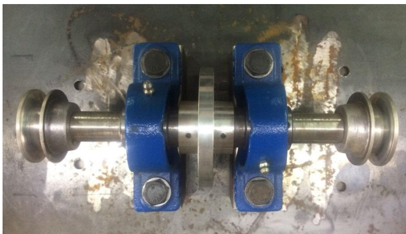
Figura 4.29 - Montagem do eixo principal no mancal com as polias e o volante de massa acoplados
