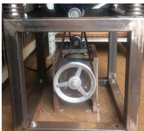
Figura 4.30 - Montagem do conjunto de transmissão do motor para o eixo principal
