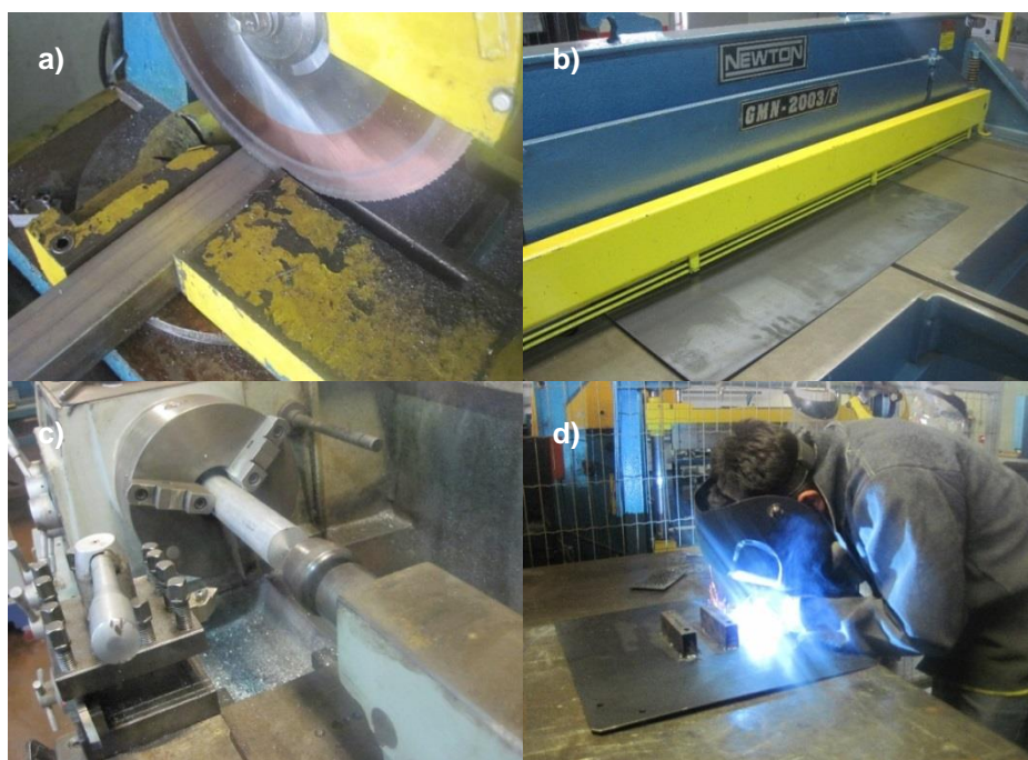
Figura 4.25 - Exemplos de processos de fabricação utilizados para fabricação dos componentes da bancada. (a) Corte; (b) Corte; (c) Torneamento; (d) Solda.
