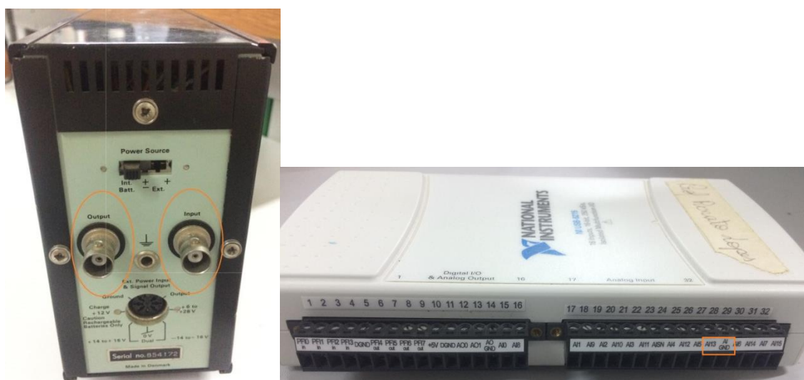
Figura 6.8 - Entrada e saída BNC do condicionador de sinais e entradas analógicas da placa de aquisição
