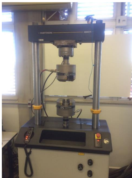
Figura 4.4 - Máquina para ensaios de tração, compressão e flexão modelo 8801 da marca INSTRON
