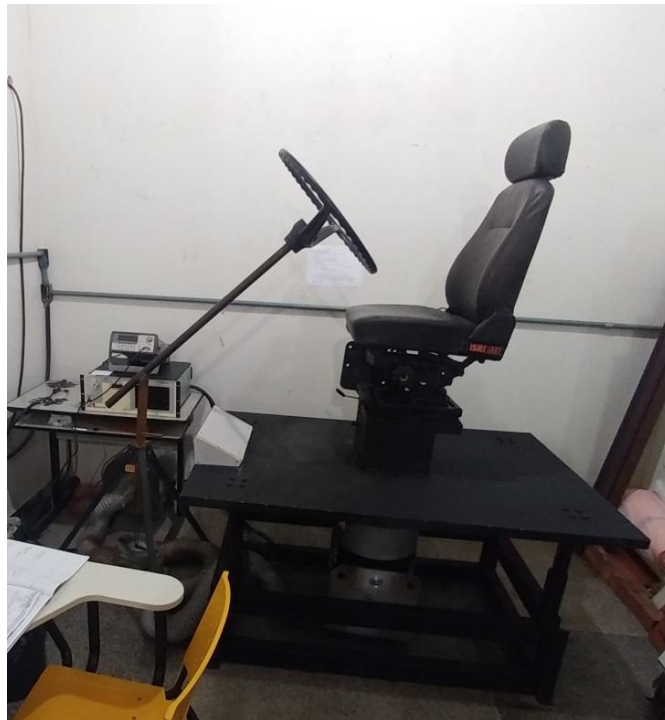
Figura 2.4 - Bancada experimental para vibração em assentos automotivos (Moore, 2017)
