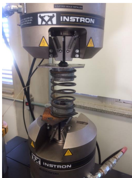
Figura 4.5 - Suporte para adaptação da mola na máquina de ensaio de compressão
