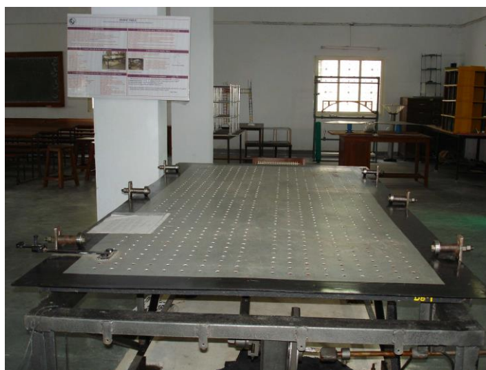
Figura 2.7 - Bancada para simulação de abalos sísmicos com amplitude máxima de 100 mm e frequência entre 0 – 4 Hz (Sanghvi, et al., 2012)
