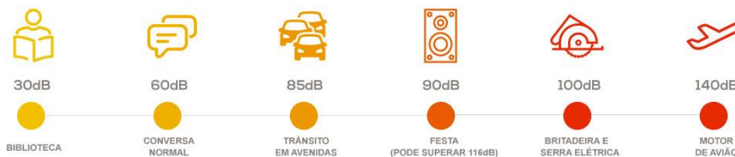
Figura 2: Escala de níveis de pressão sonora Fonte: Site Conforto Acústico
