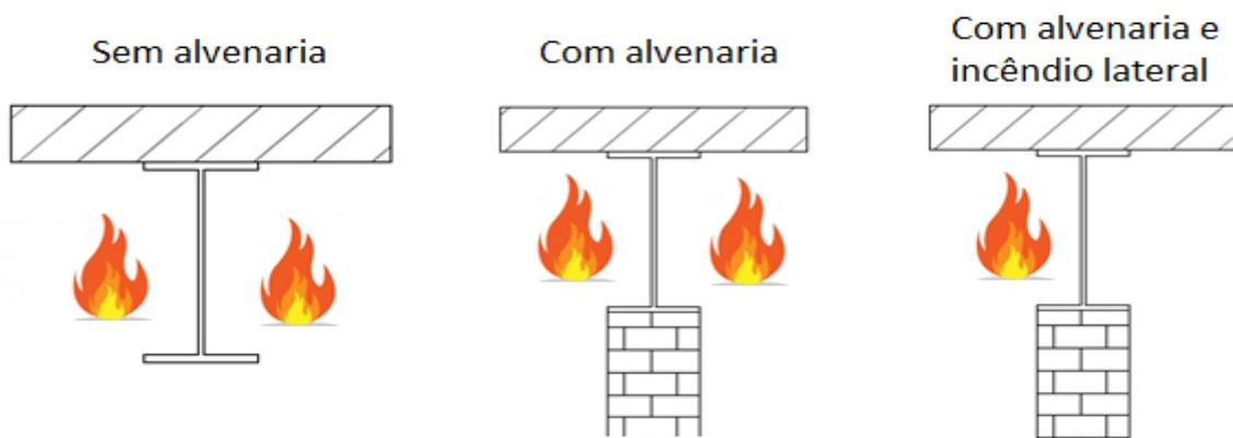
Figura 4.1 Condições de incêndio analisadas
