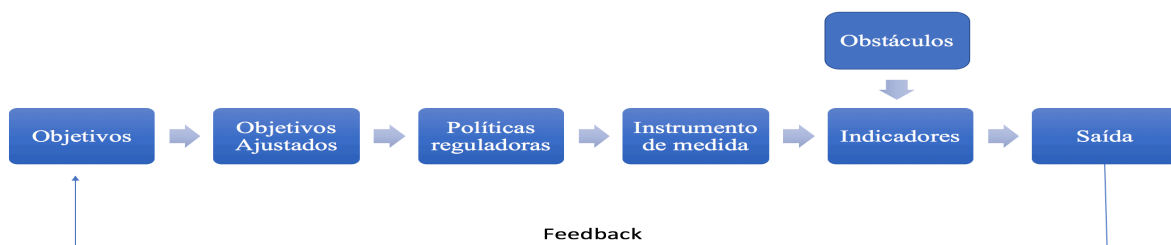
Figura 2.4 – Controle do feedback (FONTE: Elaboração própria do autor a partir de informações coletadas em KÖLBL et al., 2008)
