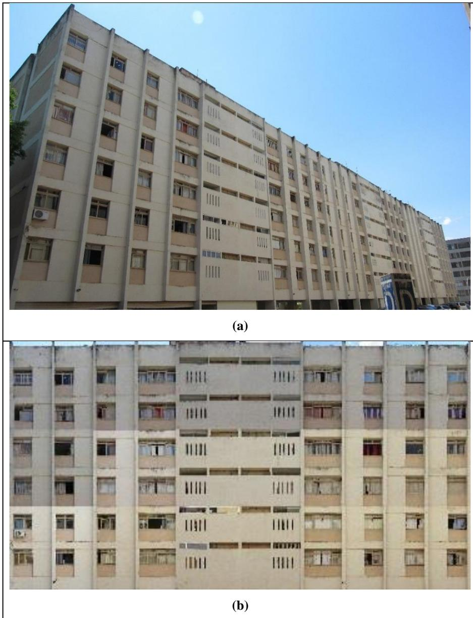
**Figura 3.3** – Comparação entre uma foto não-ortogonalizada (a) e panorama ortogonalizado (b).
