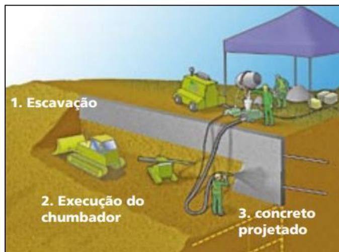
Figura 5.4 - Execução de um Solo Grampeado
