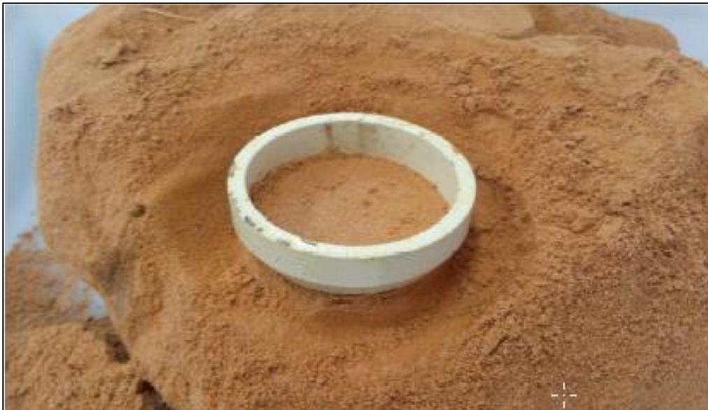
Figura 3.4 - Corpo de prova saturado. (Imagem por Ester Cristina Fritscher, 2016).
