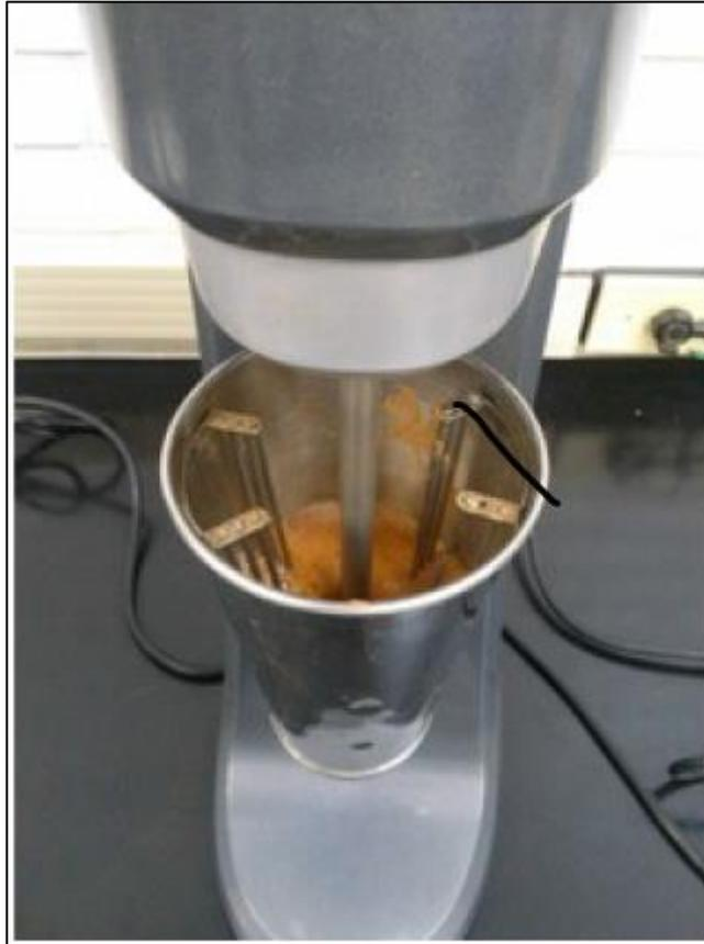
Figura 3.3 - Agitador mecânico no ensaio de massa específica (Imagem por Ester Cristina Fritscher, 2016)
