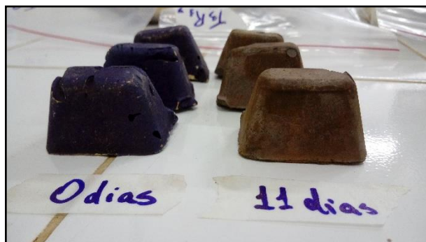
Figura 2: Mudança na coloração dos blocos de permanganato de potássio do dia zero para o último dia de armazenamento. (Brasília, novembro de 2016)
