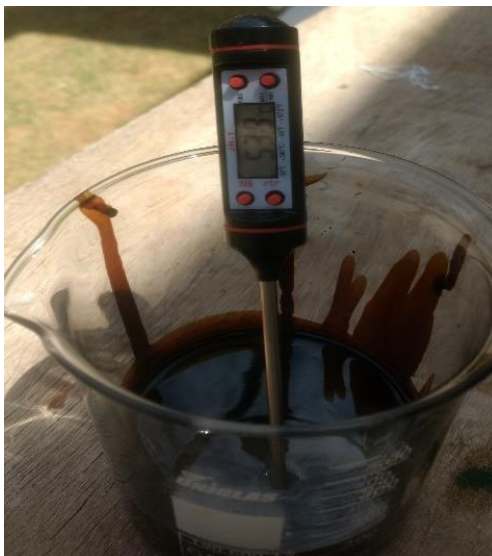
Figura 54. Aferição de temperatura da mistura após passagem pelo sistema de aquecimento
