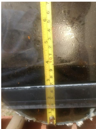
Figura 29. Aferição de altura de interface a temperatura ambiente
