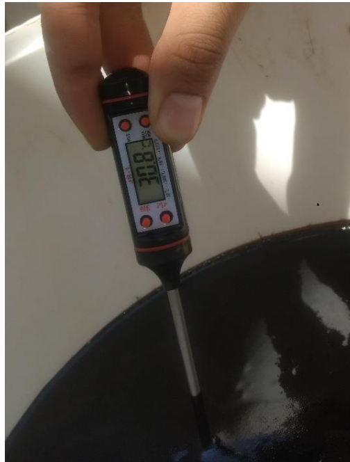
Figura 52. Aferição de temperatura de mistura antes da passagem pelo sistema T:30,8°C
