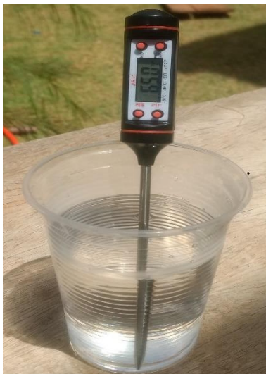
Figura 53. Aferição de temperatura da água do galão T: 65°C
