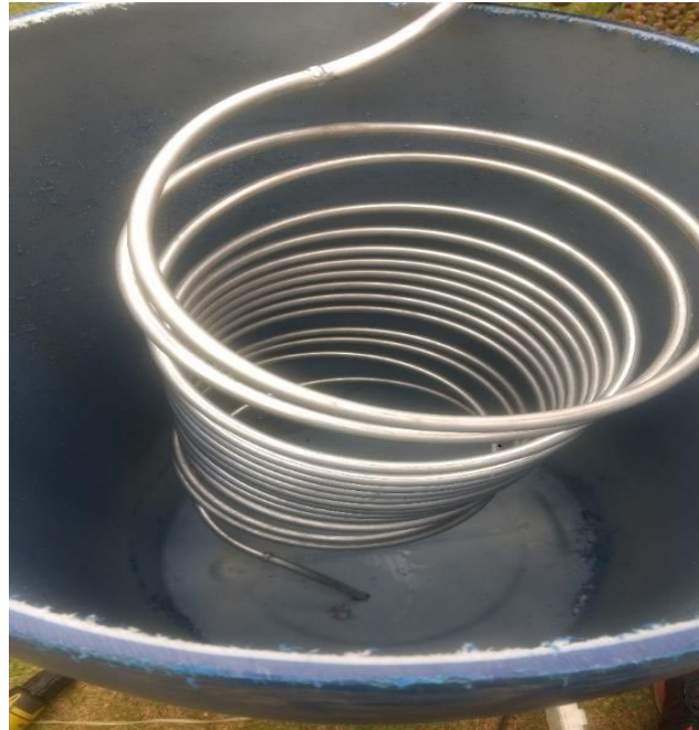
Figura 23. Serpentina conectada ao galão
