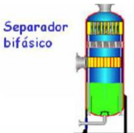
Figura 12. Separador bifásico vertical (THOMAS, 2004)
