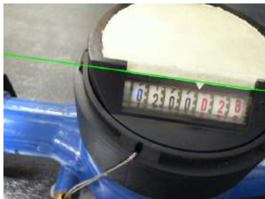
(a) Reta detectada pela transformada de Hough ( \theta_{resol} = 1^\circ , \rho_{resol} = 1 e L_{vts} = 100 ).
