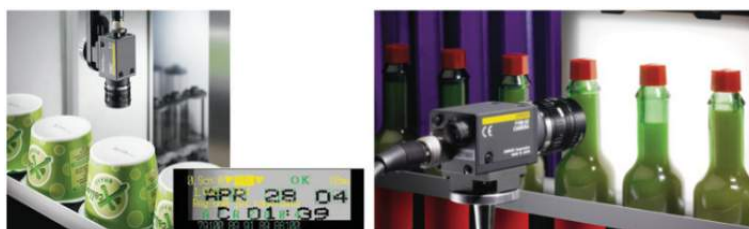
Figura 2.31: Checagem da qualidade de impressão de datas de validade (esquerda), e monitoramento de nível até o qual as garrafas devem ser enchidas (direita) [17].
