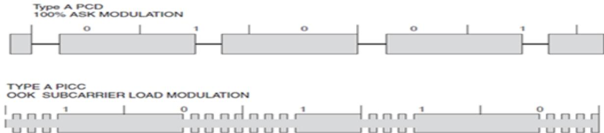
Figura 10 – Modulação entre o leitor e a tag para o cartão tipo A(ISO/IEC, 2005)
