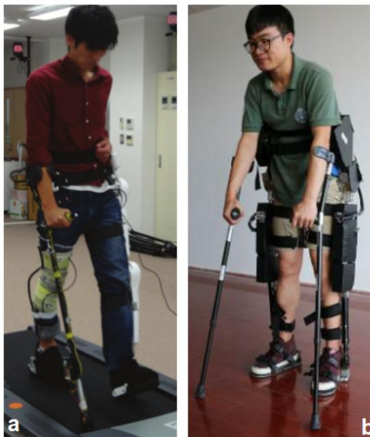
Figura 2 – Exoesqueletos de membros inferiores: a. destinado a hemiplégicos desenvolvido por [Hassan et al. \(2014\)](#). b. destinado a paraplégicos desenvolvido por [Zhu et al. \(2016\)](#).
