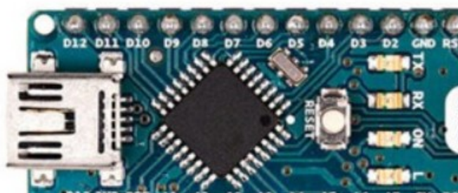
Figura 24: Arduino Nano que possui o micro controlador ATmega328.
