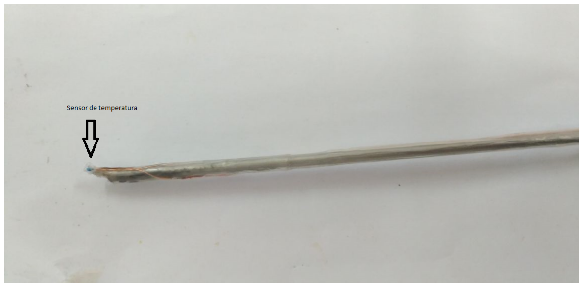
Figura 22 – Adaptação realizada no eletrodo guarda-chuva de 5 hastes para tirar o contato do sensor de temperatura no tubo que corre a radiofrequência (Autoria própria).
