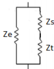
Figura 3 – Circuito proposto sobre as impedâncias atuantes durante um processo ablativo (Adaptado pelo autor)
