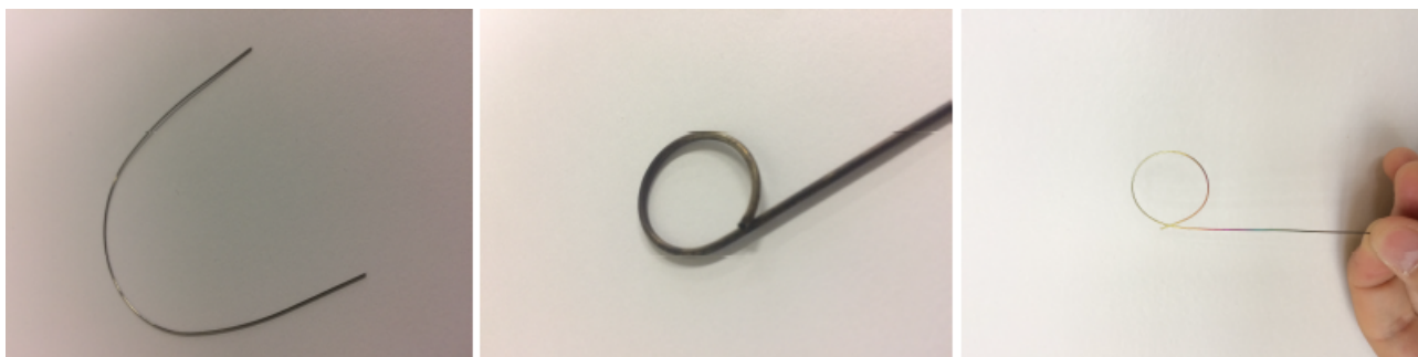
Figura 11 – Fio de arco ortodôntico (imagem à esquerda), molde para memorização feita de aço inox (imagem do meio) e fio memorizado depois de sofrer altas temperaturas (imagem à direita) (SOUZA, 2016).
