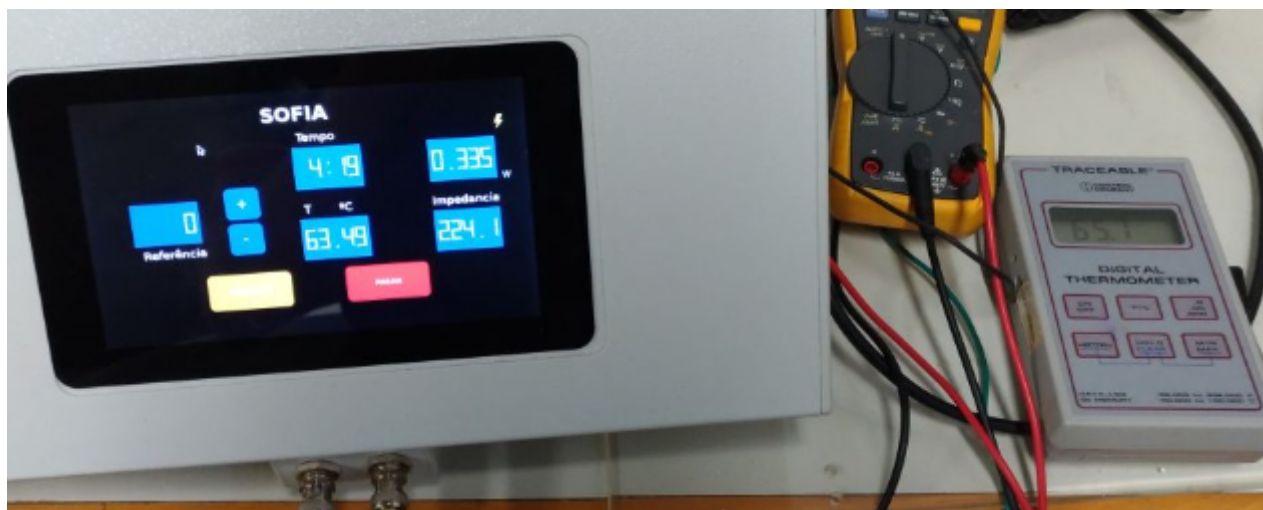
Figura 17 – Temperatura medida no SOFIA de 63.49°C e no termômetro digital de 65.7°C (Autoria própria).
