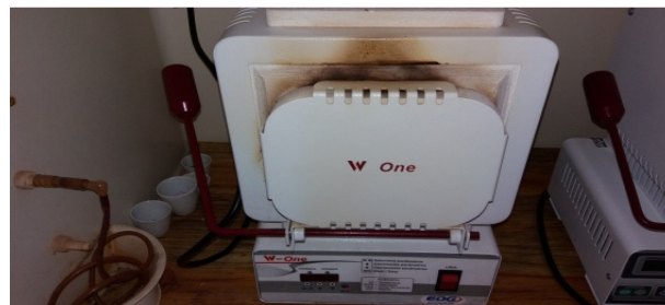
Figura 23: Forno utilizado para redução térmica do óxido de grafeno standard.
