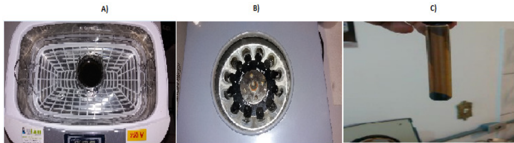
Figura 20 – A) banho ultrassônico; B) processo de centrifugação; C) fase líquida e fase sólida.
