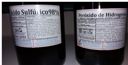
Figura 16: Acido Sulfúrico e Peróxido de Hidrogênio Utilizados na Etapa de Síntese Química de Grafite em Pó.
