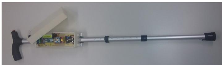
Figura 45 – Posicionamento da central eletrônica na bengala.
