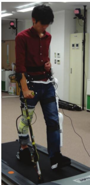
Figura 4 – Bengala instrumentada para controle de exoesqueleto robótico (Hassan et al. (2014)).
