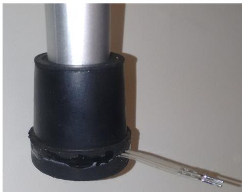
Figura 43 – Posicionamento do sensor de força.
