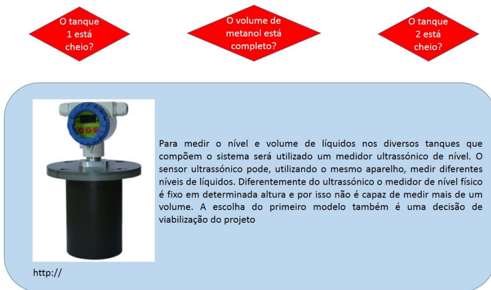
Figura 31 – Eventos de decisão onde medidores de nível são usado para ler os volumes dos tanques
