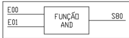
Figura 14 – Bloco de função, com função 'AND' (IEC, 1996).
