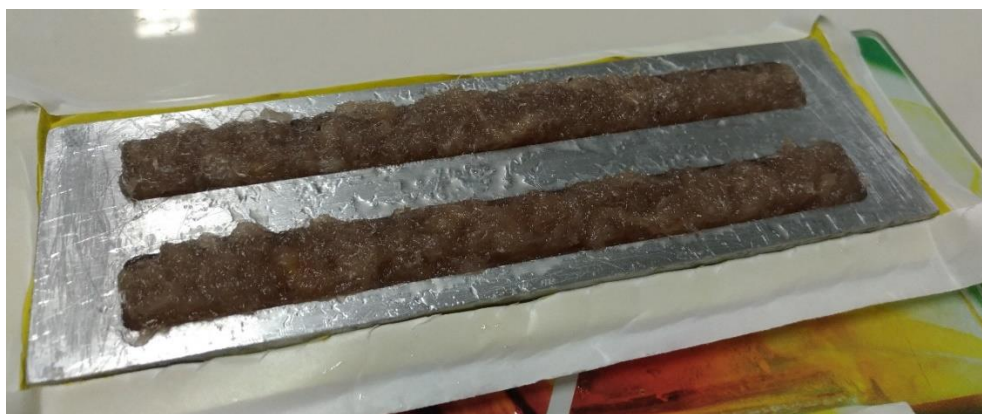
Figura 18. Aspecto do molde preenchido antes da cura
