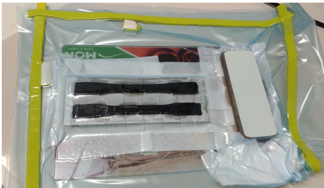
Figura 21. Aspecto do sistema sob vácuo, envolto pela vacuum bag e selado com tacky tape
