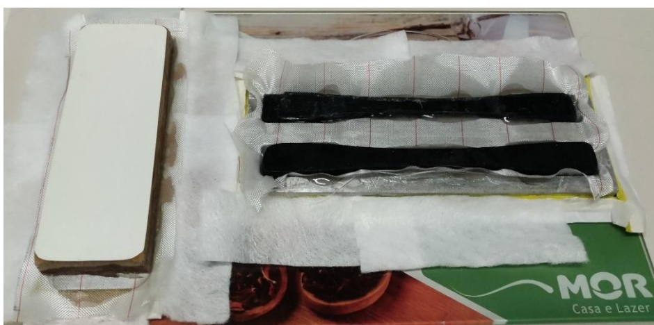
Figura 20. Aspecto do sistema com peças encaixadas sobre os moldes para prensá-los
