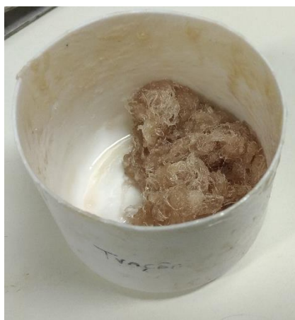
Figura 17. Aspecto da mistura das fibras com a resina e catalisador
