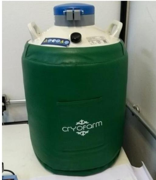
**Figura 3.7 - Tanque de nitrogênio líquido**
