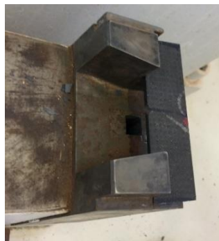
Figura 14 – Corpo de prova posicionado para o ensaio de impacto.
