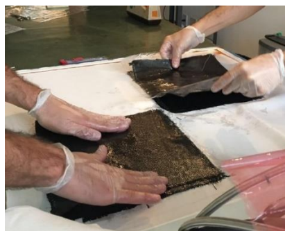
Figura 18 - Impregnação de resina manual.
