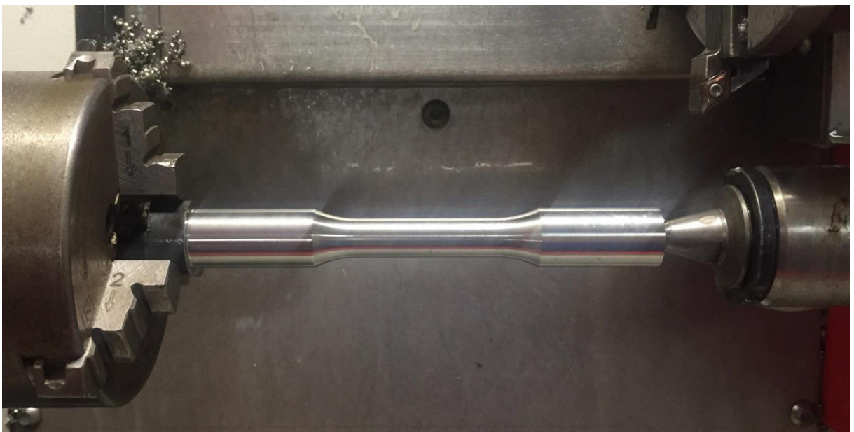
Figura 48 - CP após a usinagem
