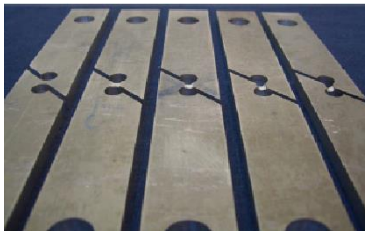
Figura 24 - Diferentes profundidades de entalhe [20]
