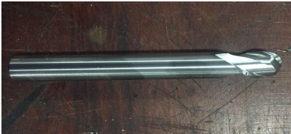
Figura 57 - Fresa de ponta esférica de 10 mm
