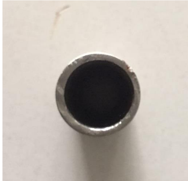
Figura 15 - Foto da seção transversal de um CP cilíndrico vazado excêntrico
