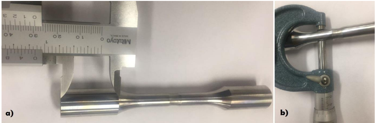
Figura 8 - a) Medição do comprimento da região da garra com um paquímetro e; b) Medição do diâmetro da seção útil do CP
