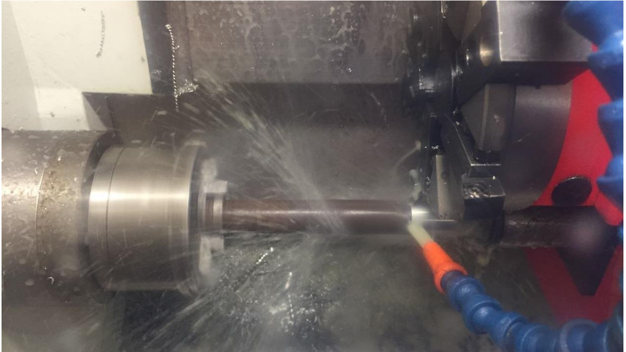
Figura 47 - Usinagem do corpo de prova
