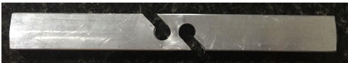
Figura 64 - CP de cisalhamento em máquina de tração finalizado
