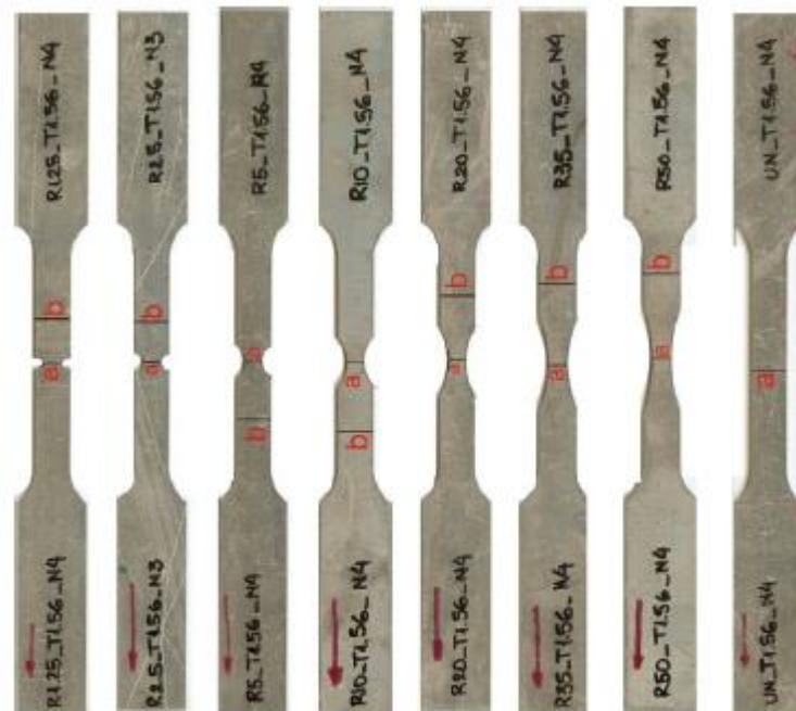
Figura 22 – Corpos de prova retangulares entalhados [20]
