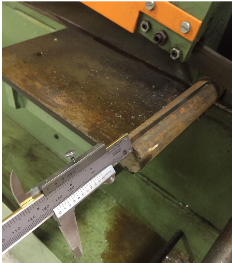
Figura 42 - Corte do tarugo em serra de fita horizontal
