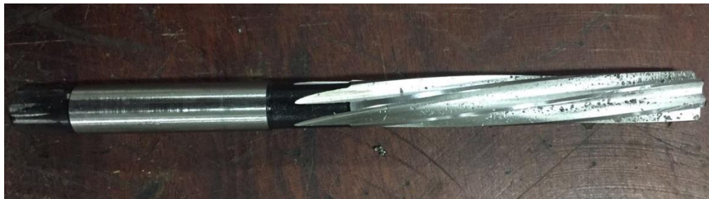
Figura 56 - Alargador de 10 mm utilizado
