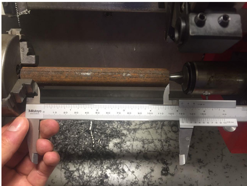
Figura 44 - Fixação do tarugo
