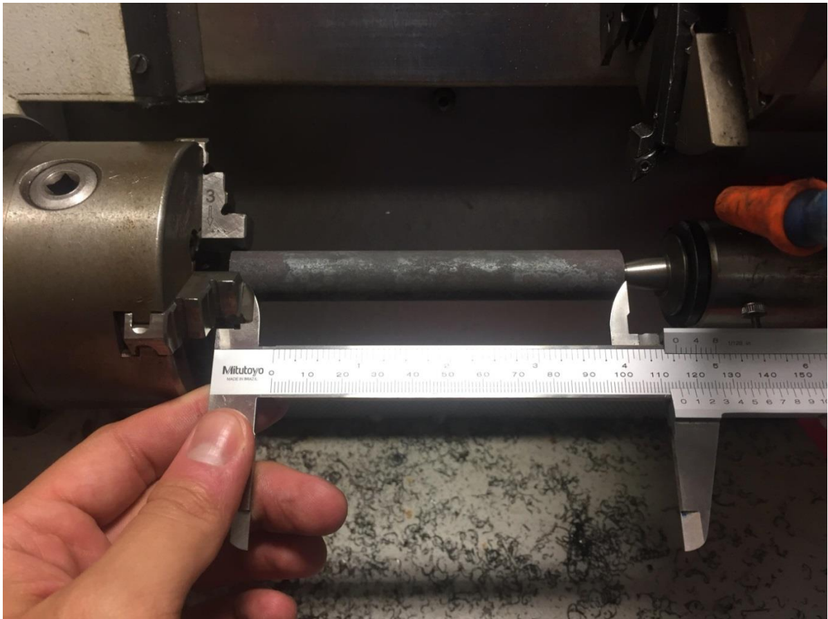
Figura 51 - Fixação do CP cilíndrico vazado
