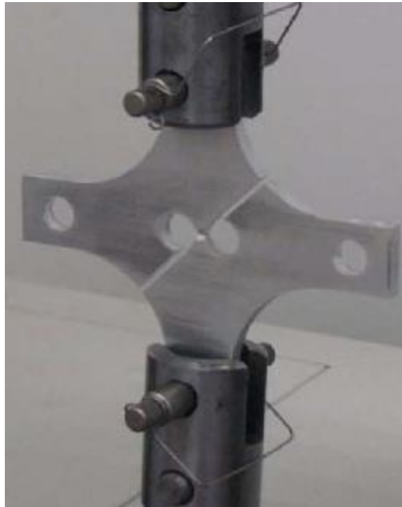
Figura 27 - Fixação na máquina de tração [20]
