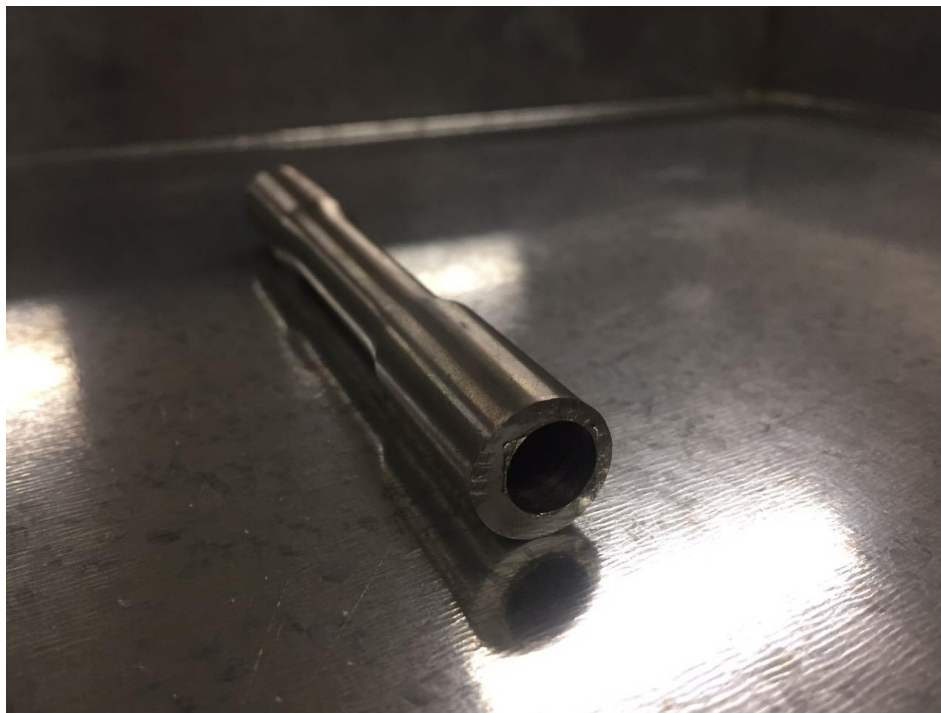
Figura 53 - Primeiro corpo de prova vazado obtido, com o furo visivelmente fora de centro
