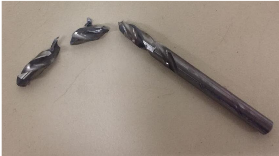
Figura 54 - Broca de 6 mm quebrada em três partes
