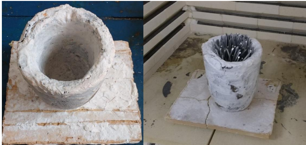
Figura 17: Cadinho revestido de material refratário e preenchido com seções de cabo.
