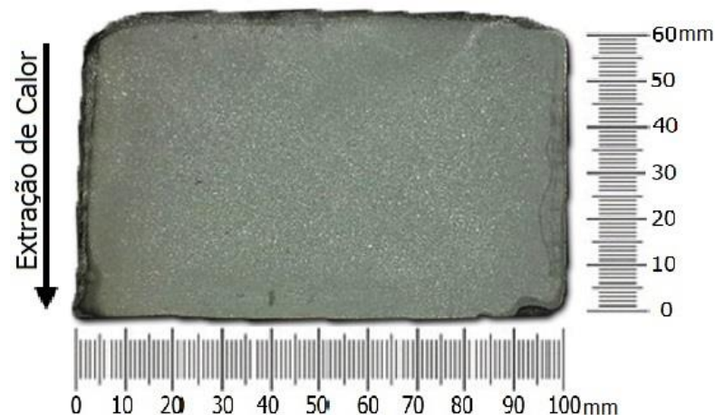
Figura 34: Macroestrutura do material solidificado, com indicação do sentido de extração de calor e escala para as dimensões do lingote expressa em mm.
