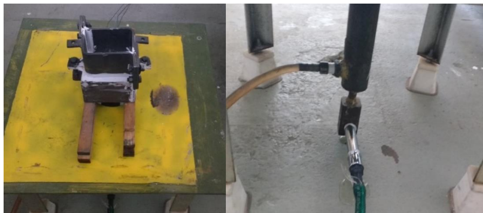
Figura 21 – Lingoteira e sistema de circulação de água para extração de calor a partir da base do molde.
