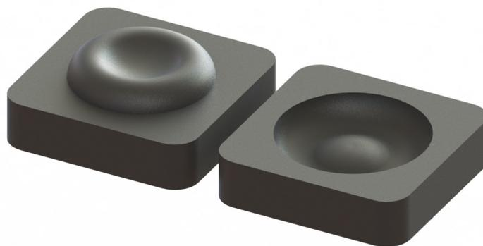
Figura 60: Modelo CAD 3D do molde para confecção da membrana da cápsula.
