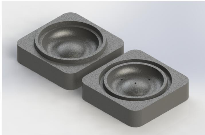
Figura 29: Modelo CAD 3D do molde de injeção.
