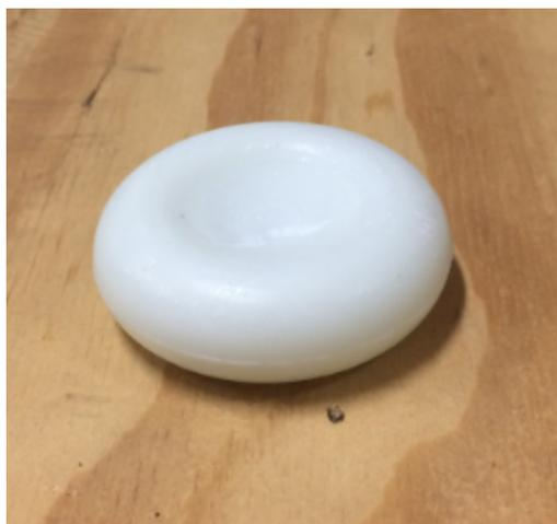
Figura 32: Cera de palma em formato de hemácia produzida pela injeção do material no molde.
