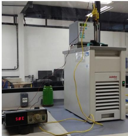
Figura 50: Ilustração do banho térmico modelo Julabo F25.
