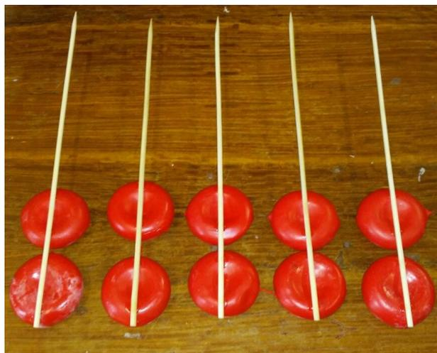
Figura 48: Esquema de fixação das cápsulas com palitos de madeira.
