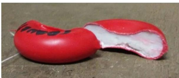
Figura 52: Cápsula cortada para medição de espessura.
