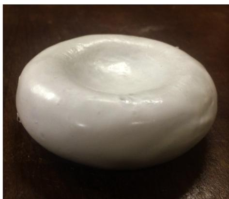
Figura 35: Cápsula finalizada pelo processo de injeção de cera no molde.
