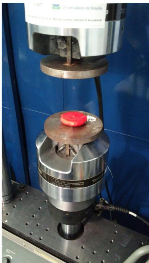
Figura 53: Cápsula com membrana rompida após ensaio compressivo.
