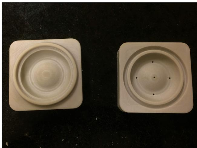
Figura 31: Moldes fabricados pela fresadora CNC.
