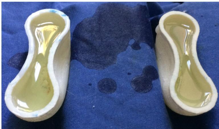
Figura 39: Injeção de cera de palma nas cápsulas impressas.
