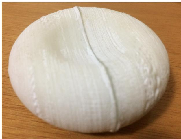
Figura 40: Montagem final da cápsula produzida por impressão 3D.
