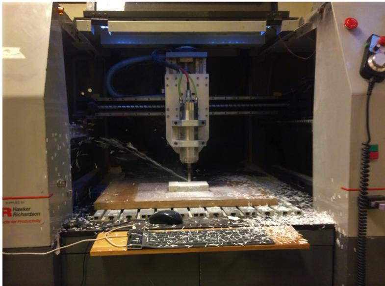
Figura 30: Fresadora CNC utilizada para confecção dos moldes.
