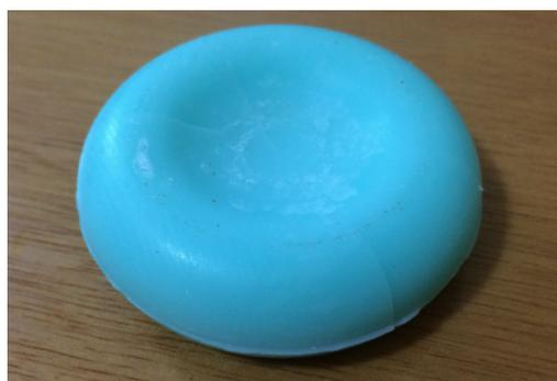
Figura 42: Mudança da coloração do material devido ao aquecimento excessivo.
