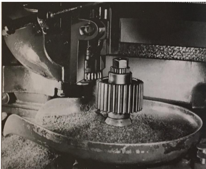
Figura 2.1. Fabricação de uma engrenagem cilíndrica de dentes retos (Budynas, et al. 2011)
