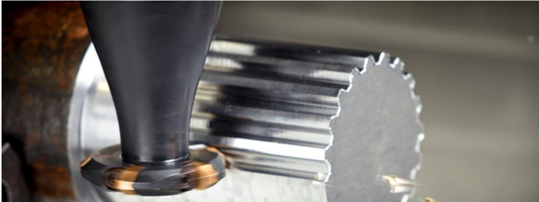
Figura 3.2. Fabricação de estrias em um eixo (< http://www.sandvik.coromant.com/pt-pt/mww/Pages/T_SplineMachining.aspx >. Acesso em 21/03/2017)
