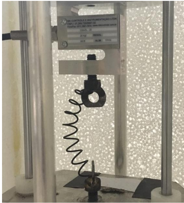
Figura 24: Detalhe da fixação da mola e célula de carga.
