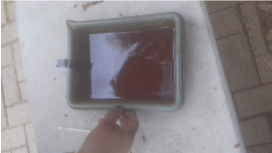
Figura 3.7: Banho de percloroeto de ferro
