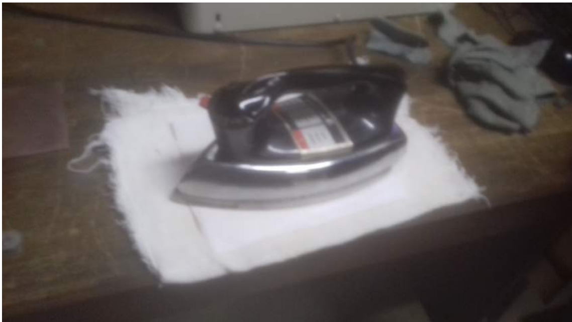
Figura 3.6: Prensando o papel couchê na placa de cobre
