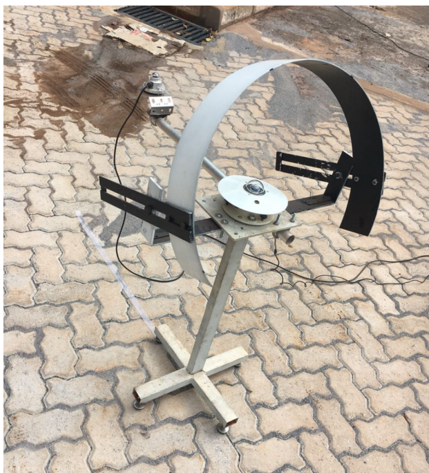
Figura 6.3. Piranômetro posicionado conforme marcação do norte solar pela fita
