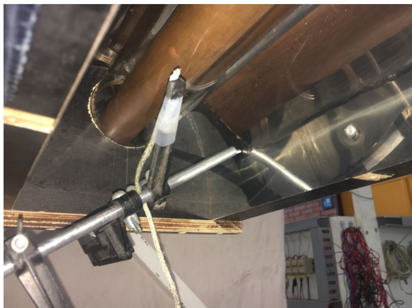
Figura 6.8. Fixação do termopar no tubo de vidro e na superfície do refletor secundário
