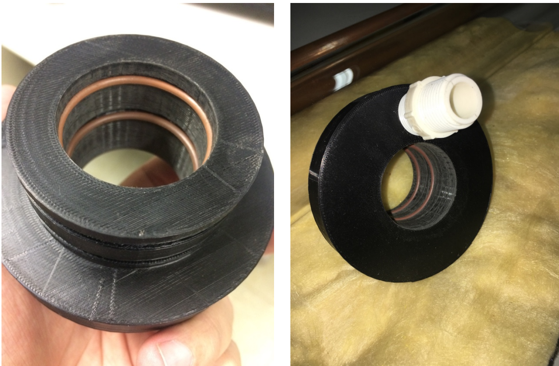
Figura 5.6. O'Rings internos alojados nas tampas do tubo evacuado
