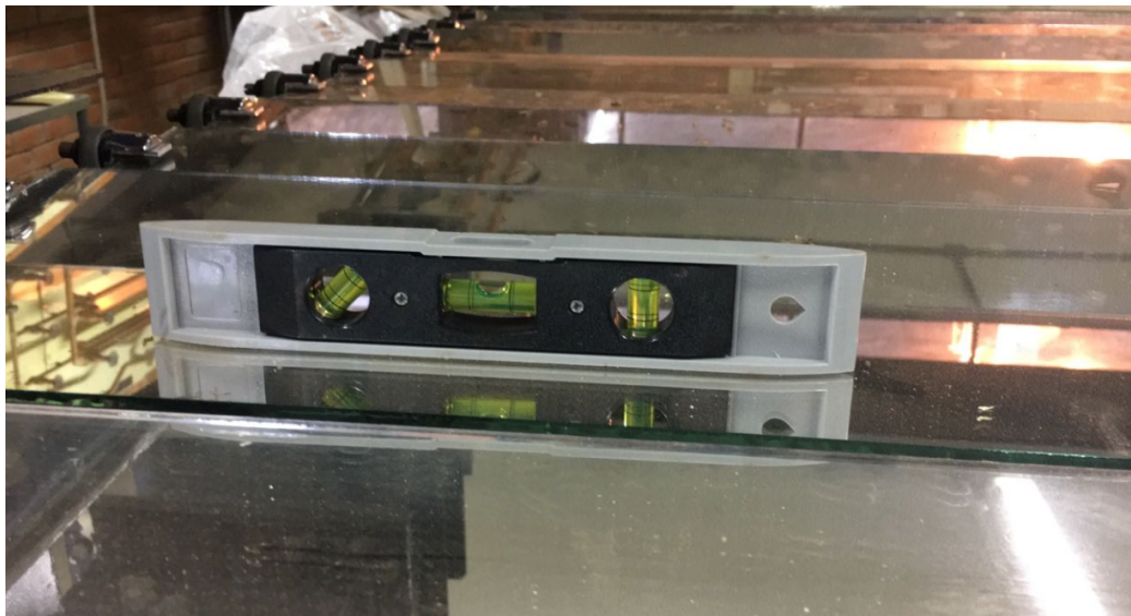
Figura 4.6. Nivelamento dos espelhos primários com um nível de bolhas
