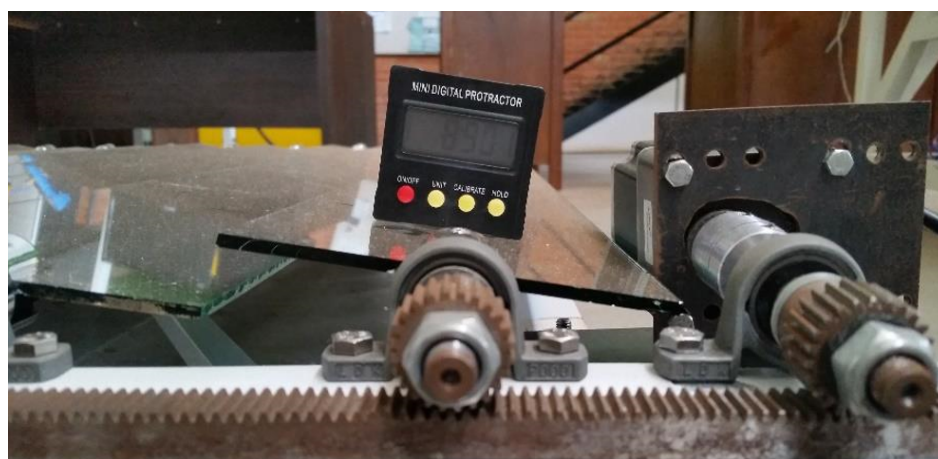
Figura 6.9. Aferição do ângulo do espelho com o inclinômetro digital
