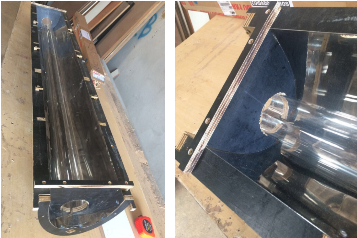
Figura 4.9. Refletor Secundário com o tubo de vidro
