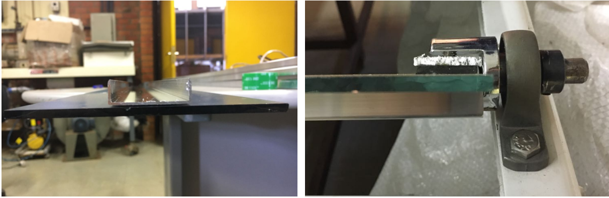
Figura 4.5. Perfil "U" fixado ao espelho e ao mancal
