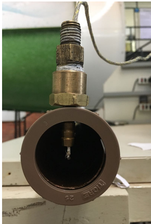
Figura 6.7. Aparato para medição de temperatura na entrada e saída do tubo absorvedor
