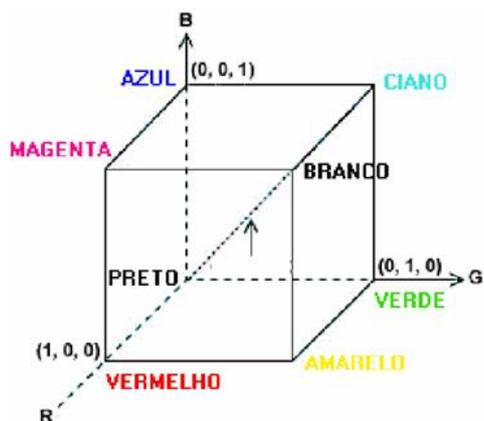
Figura 2.6: Cubo com os valores dos eixos normalizados, representando o espaço de cores RGB. Retirado de [2].
