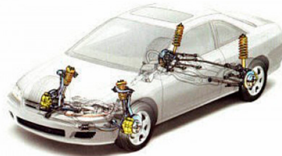
Figura 2 – Sistema de suspensão independente no eixo dianteiro e traseiro. Fonte: disponível em < http://oficinaviera.com.br/site/dicas/109-sistema-de-suspensao >, acesso em 27 de jun. 2017.
