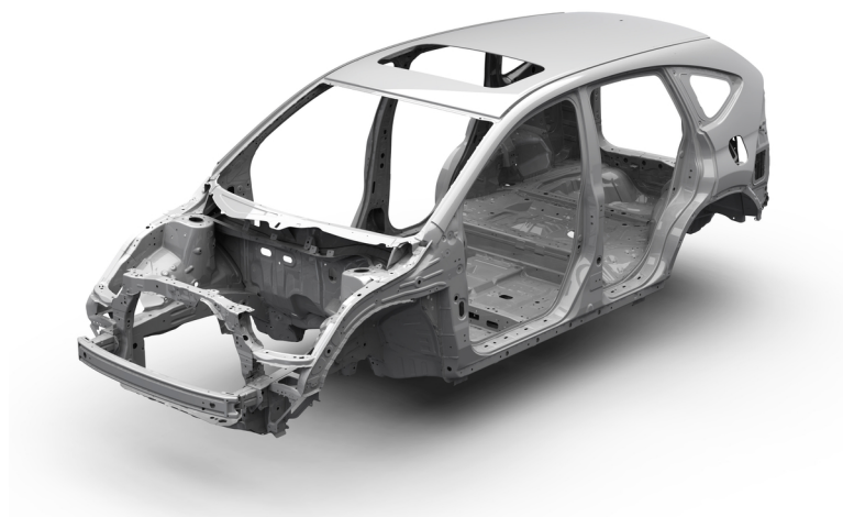
Figura 4 – Exemplo de body in white (BIW) de um veículo. Fonte: disponível em < http://www.autoguide.com/blog/wp-content/uploads/2015/02/Honda-Body-in-White.jpg >, acesso em 27 de jun. 2017.
