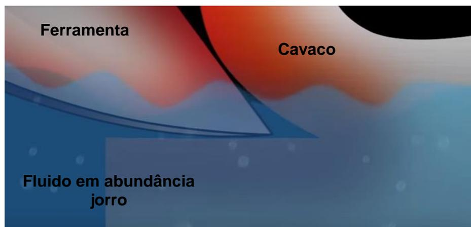
Figura 2.5 - Sistema convencional por jorro atuando na usinagem. Fonte: MGUV, 2010.
