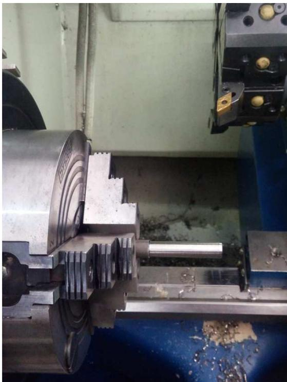
Figura 2 - Torneamento cilíndrico externo na usinagem de titânio. (Fonte: próprio autor).
