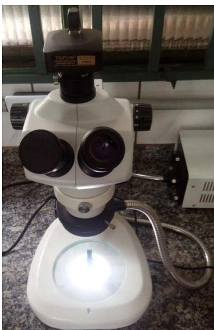
Figura 4 - Estereomicroscópio utilizado para medição do desgaste de flanco.
