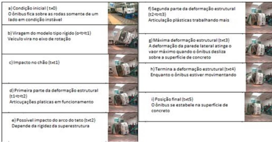
Figura 23 - Etapas do teste de capotamento de um veículo completo
